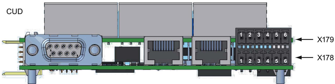
图 6-59 X178和X179的引脚布局
