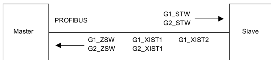
图 10-4 编码器接口示例（编码器 1：两个实际值，编码器 2：一个实际值）
