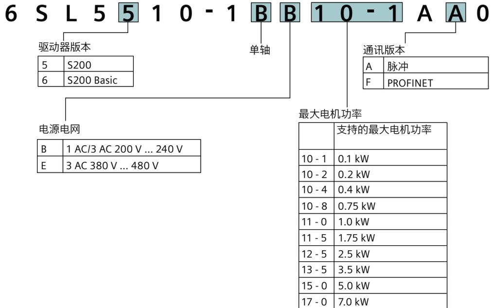
图 3-5 S200 驱动器产品线的订货号
