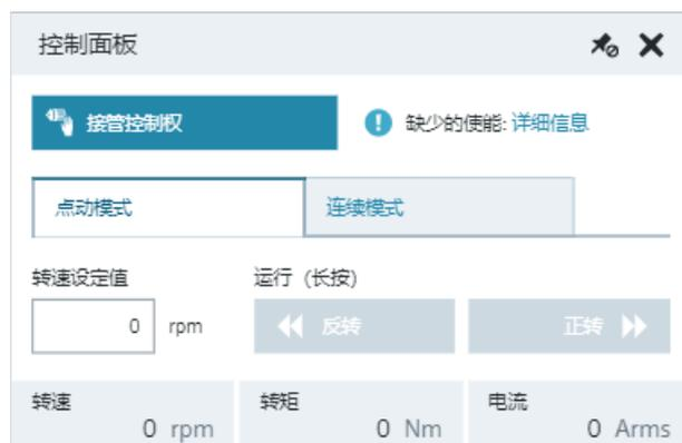
图 7-4 通过控制面板测试驱动器配置
