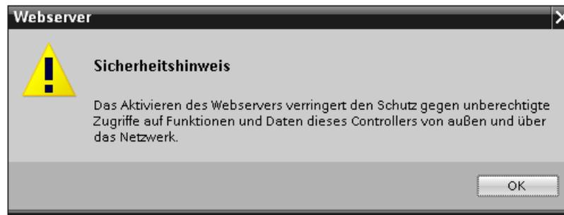
Bild 3-1 Sicherheitshinweis bei der Aktivierung des Webserver in STEP 7
