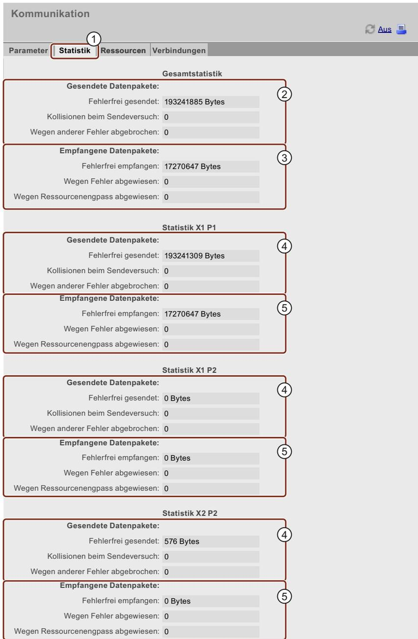
Bild 4-34 Register "Statistik" mit Kennzahlen zur Datenübertragung
