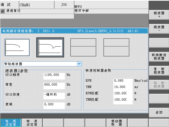
图 11-5 带阻为 1190 Hz 的转速调节回路过滤器
