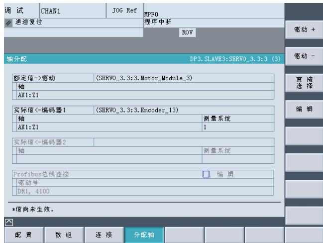
图 9-3 分配轴至驱动的设置值和实际值
