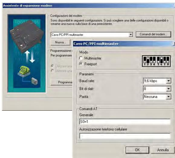
Figura 7-28 Assistente modem – Trasmissione dei comandi per il modem in modo freeport
