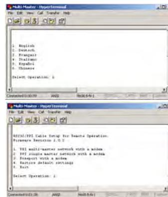
Figura 7-40 Lingue selezionabili in HyperTerminal e configurazione del cavo RS-232/PPI
