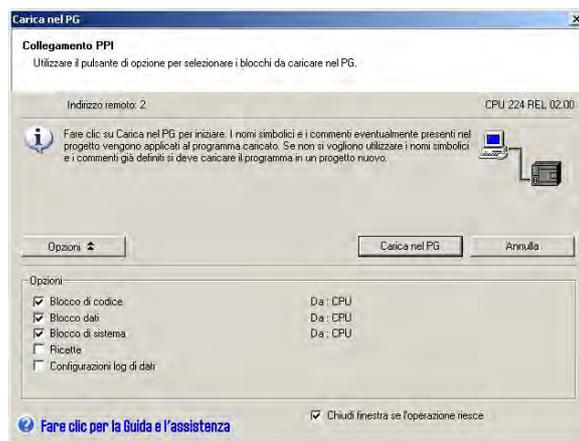
Figura 4-15 Caricamento di un progetto dalla CPU S7-200
