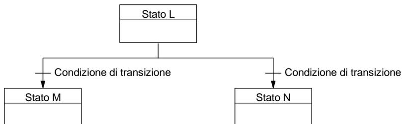
Figura 6-34 Divergenza di un flusso di controllo in funzione di una condizione di transizione
