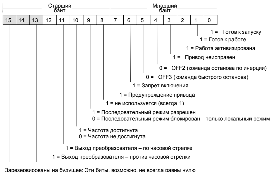
Рис. 11–3. Биты состояния для стандартного слова состояния для MicroMaster 3 и главной обратной связи
