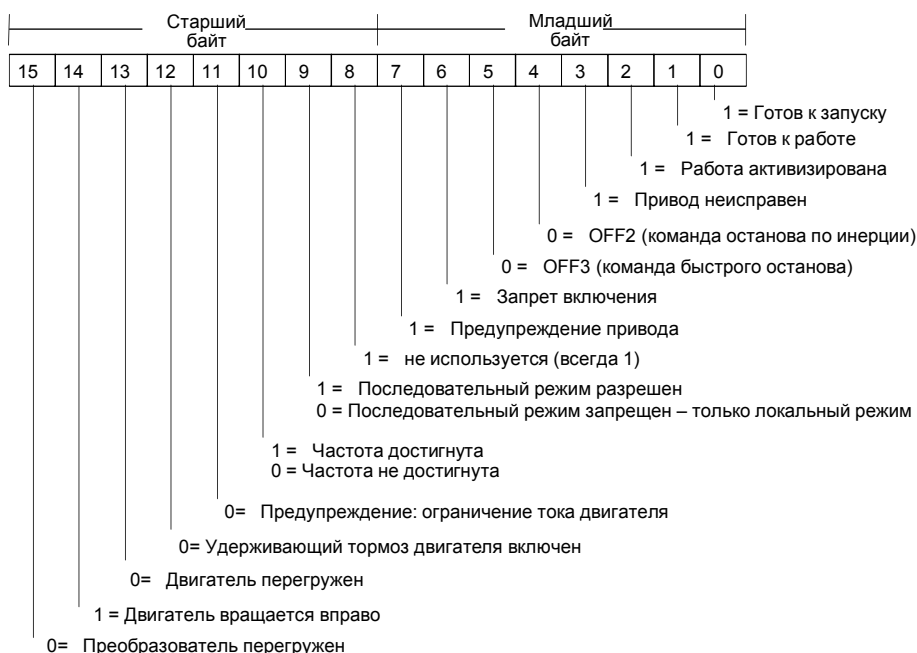
Рис. 11–4. Биты состояния для стандартного слова состояния для MicroMaster 4 и главной обратной связи
