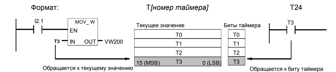
Рис. 4–5. Обращение к биту или к текущему значению таймера
