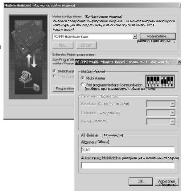
Рис. 7–27. Мастер настройки модема - передача команд для модема
