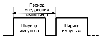
Рис. 6-30. Широтно-импульсная модуляция (PWM)
