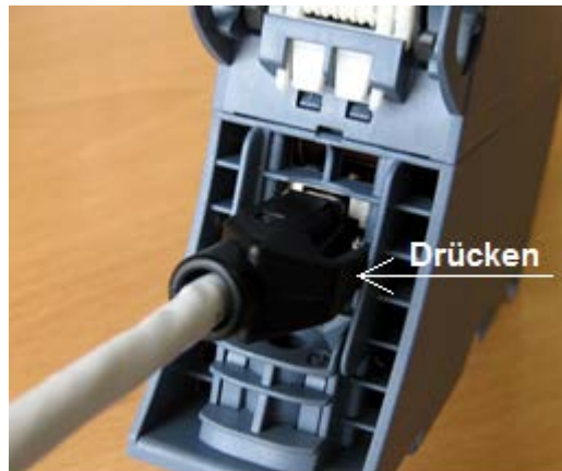
Bild 4-9 Ethernet-Kabel in Buchse drücken
