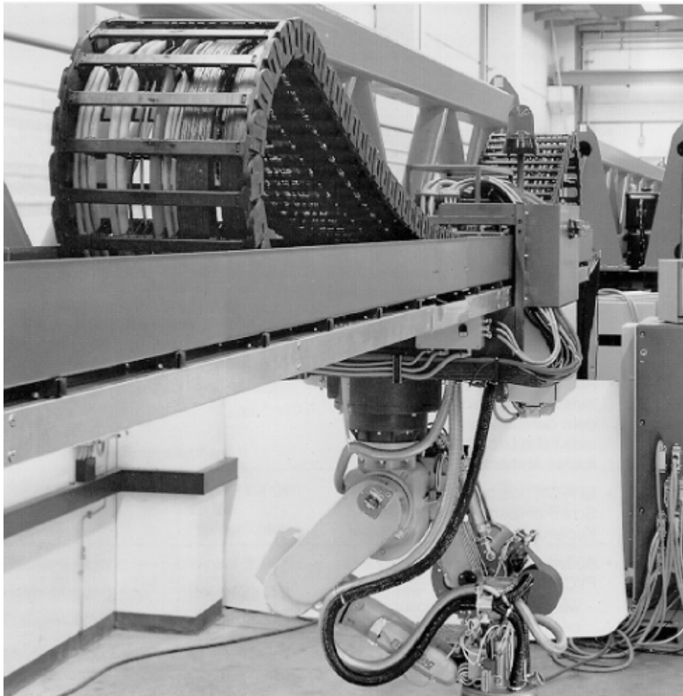
Figure 5-8 Exemple de mise en oeuvre du câble chenillable PROFIBUS sur chenille porte-câbles
