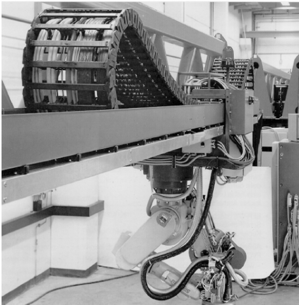
Figure 7-10 Exemple de mise en oeuvre du câble chenillable FO verre sur chenille porte-câbles
