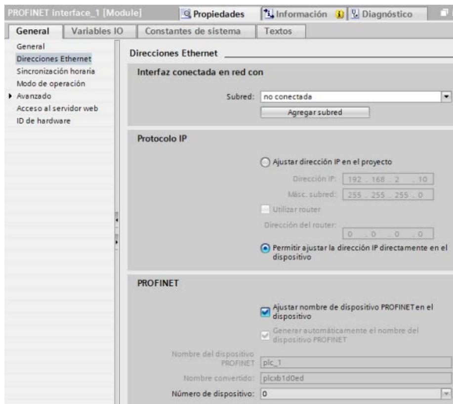
**Ejemplo: Uso de la instrucción T\_CONFIG para cambiar las direcciones IP en los servidores NTP**
