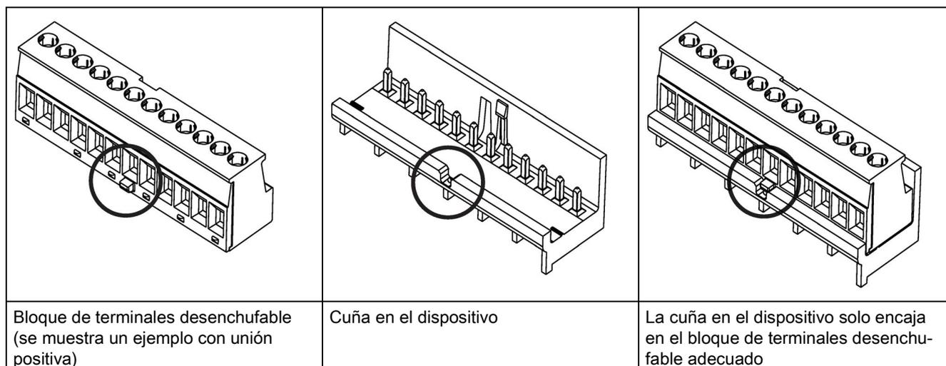
Tabla C- 16 Kits de repuesto de bloques de terminales para CPUs S7-1200 V4.0 y superiores
