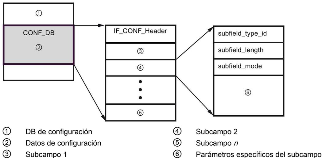
Los datos de configuración del CONF\_DB se componen de un campo que contiene un encabezado (IF\_CONF\_Header) y varios subcampos. IF\_CONF\_Header ofrece los siguientes elementos:
