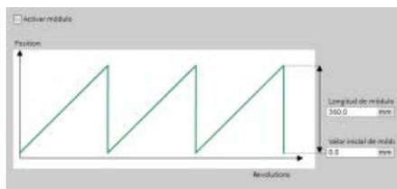
**Modulo:** Se puede configurar un eje "Modulo" para mover la carga en un área cíclica con un valor o posición de arranque y una longitud dada. Si la posición de la carga llega al final de esta área, se vuelve a poner automáticamente al valor de arranque. Los campos "Longitud" y "Valor inicial de módulo" se activan al hacer clic en la casilla de verificación "Activar Modulo".
