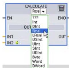
Haga clic en "???" y seleccione los tipos de datos de los parámetros de entrada y salida. (Los parámetros de entrada y salida deben tener un mismo tipo de datos).
