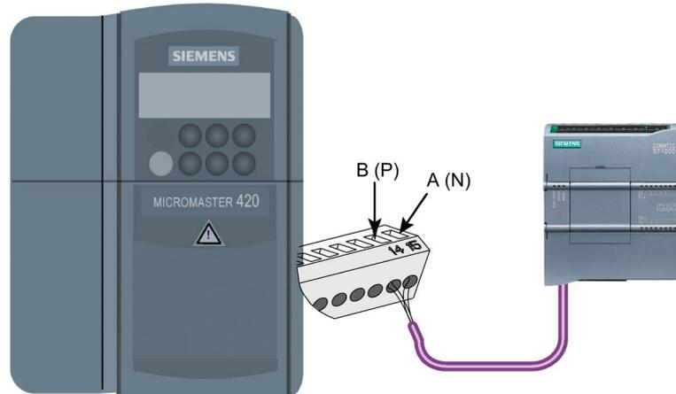
Las conexiones del bloque de terminales están etiquetadas de forma numérica. Utilizando un conector PROFIBUS en el lado del S7-1200, conecte el terminal A del cable al terminal 15 del accionamiento (si es un MM420), o bien al terminal 30 (si es un MM440). Conecte el terminal B del cable B (P) A (N) al terminal 14 (si es un MM420), o bien al terminal 29 (si es un MM440).
