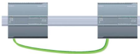
Una CPU conectada a otra CPU
