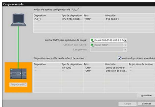
La función de la CPU "Cargar en dispositivo" y el diálogo "Carga avanzada en dispositivo" permiten visualizar todos los dispositivos de red accesibles y asegurar que se han asignado direcciones IP unívocas a todos ellos. Este diálogo muestra todos los dispositivos accesibles y disponibles con sus respectivas direcciones MAC o IP asignadas. Las direcciones MAC son especialmente importantes para identificar dispositivos que no disponen de la dirección IP unívoca necesaria.
