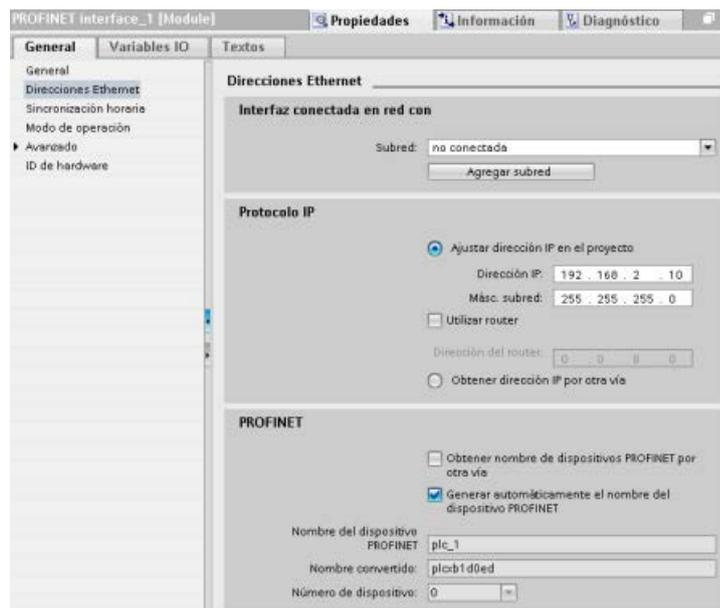
**Propiedades de direcciones IP:** En la ventana de propiedades, seleccione la entrada de configuración "Direcciones Ethernet". STEP 7 muestra el diálogo de configuración de direcciones Ethernet, en el que el proyecto de software se asocia a la dirección IP de la CPU que lo recibirá.
