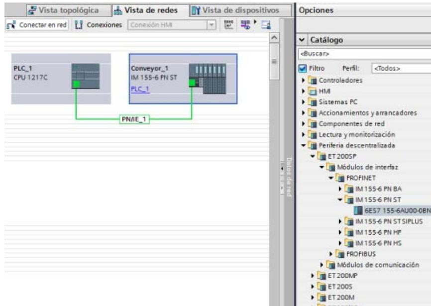
3. Agregue el módulo TM Pulse ET 200SP:
