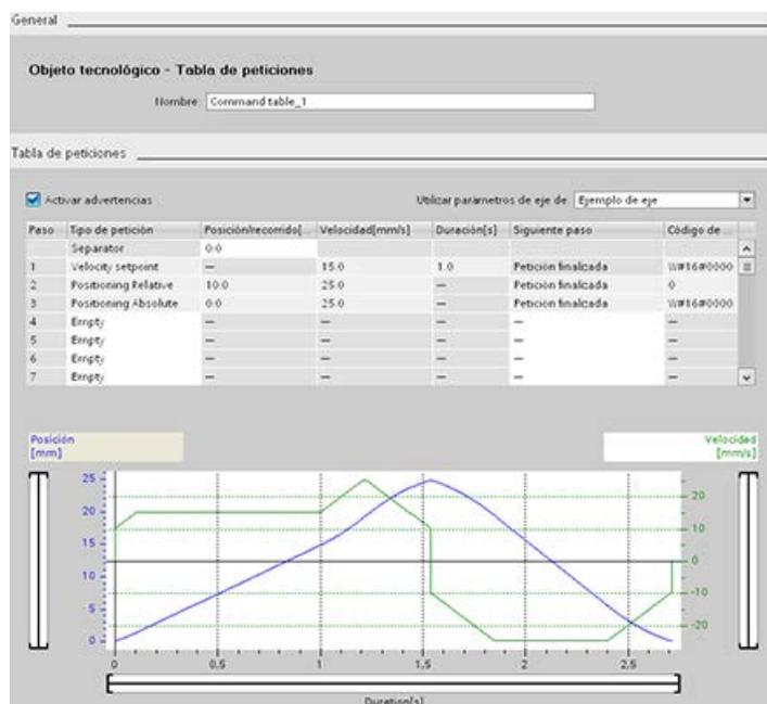
Se pueden seleccionar los tipos de comandos que se van a utilizar para procesar la tabla de comandos. Se pueden introducir hasta 32 tareas. Los comandos se procesan en secuencia.
