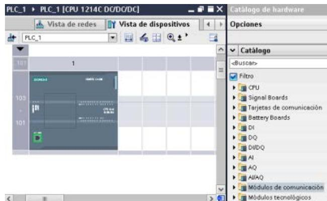
Al seleccionar la CPU en la vista de dispositivos se visualizan las propiedades de la CPU en la ventana de inspección.
