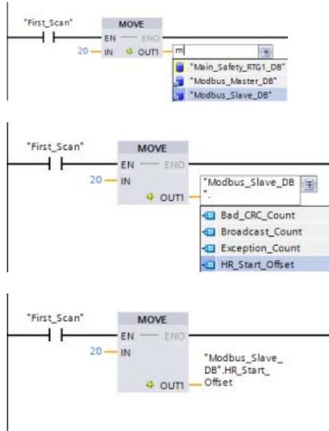
Introducir una variable de esclavo Modbus utilizando el nombre de DB predeterminado:
