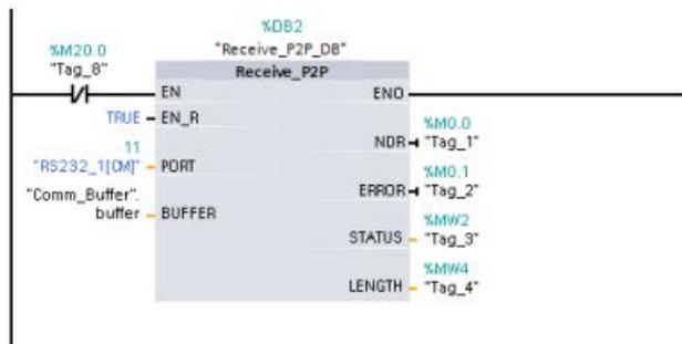
**Segmento 2:** utilice el valor NDR (Tag\_1 en M0.0) activado por la instrucción RCV\_PTP para hacer una copia del número de bytes recibidos y para activar una marca (Tag\_8 en M20.0) con el fin de lanzar la instrucción SEND\_PTP.
