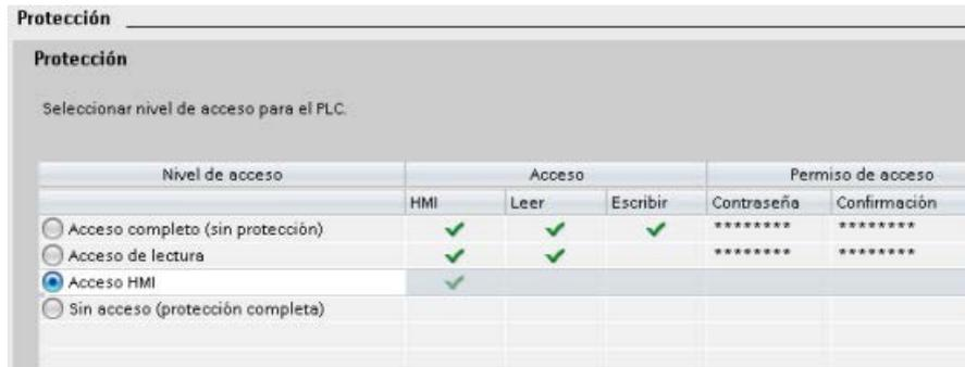
Cuando se descarga esta configuración a la CPU, el usuario dispone de acceso HMI y puede acceder a funciones HMI sin una contraseña. Para leer datos o comparar los bloques lógicos offline/online, el usuario debe introducir la contraseña configurada para "Acceso de lectura" o la contraseña para "Acceso completo (sin protección)". Para escribir datos, el usuario debe introducir la contraseña configurada para "Acceso completo (sin protección)".
