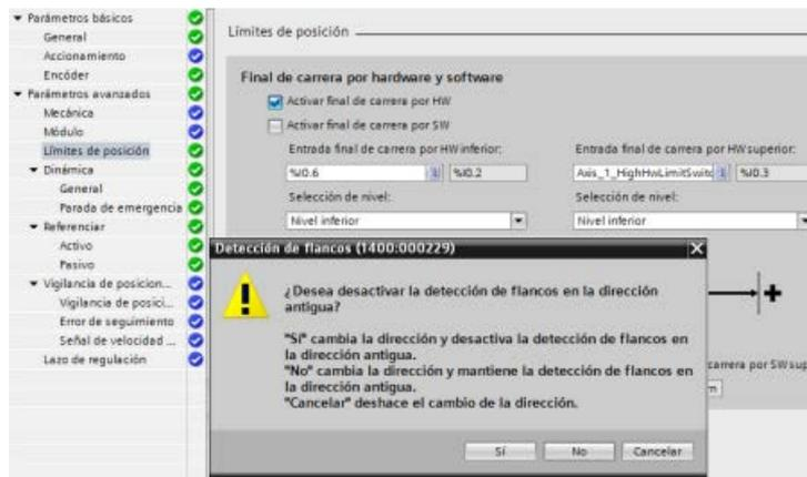
3. La CPU acepta la nueva dirección IO.6 y activa la detección de flancos en IO.6. La detección de flancos de IO.2 en las propiedades de la CPU, Entradas digitales, se mantiene activada:
