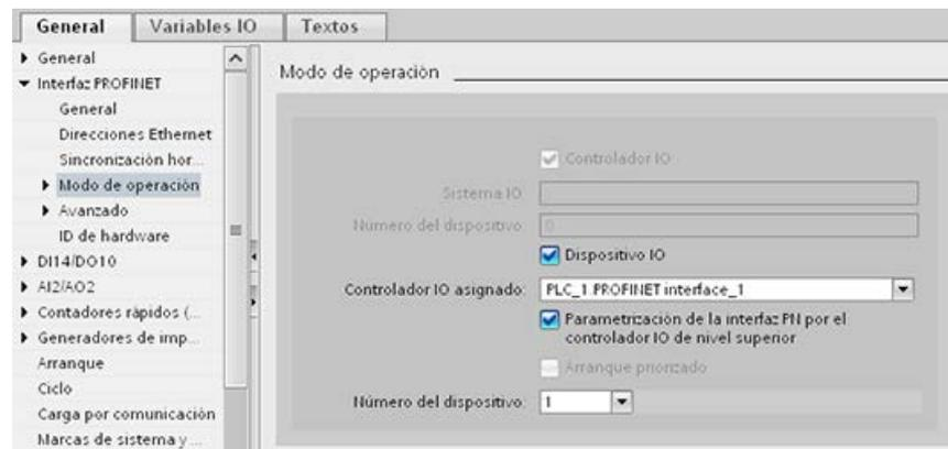
6. Mediante la casilla de verificación "Parametrización de la interfaz PN por el controlador IO de nivel superior", se especificará si el propio I-device o bien un controlador IO de nivel superior asignarán los parámetros de interfaz.
