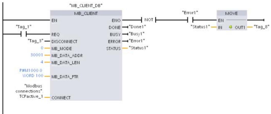
**Segmento 2:** Función Modbus 3: leer palabras de registro de retención de un servidor Modbus TCP
