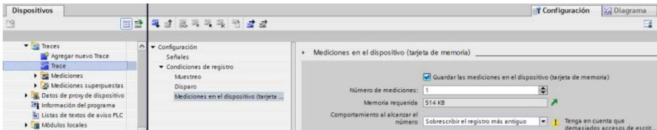
La CPU soporta un máximo de 999 resultados de mediciones de seguimiento. Mientras la CPU guarda las mediciones de seguimiento en la memoria de carga, no comprueba la condición de disparo para la tarea de seguimiento. Una vez la CPU termina de guardar las mediciones de seguimiento, vuelve a comprobar las condiciones de disparo.
