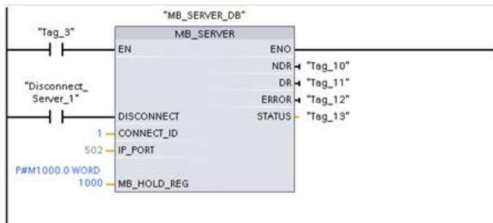
**Segmento 2:** Conexión n.º 2 con IP\_PORT, ID de conexión y DB de instancia independientes
