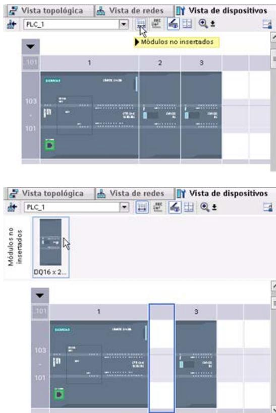
STEP 7 dispone de un área de almacenamiento para módulos "no enchufados". Puede arrastrar un módulo desde el rack para guardar la configuración del módulo en cuestión. Estos módulos desenchufados se guardan con el proyecto, permitiendo así volver a insertarlos en el futuro sin necesidad de configurar los parámetros.
