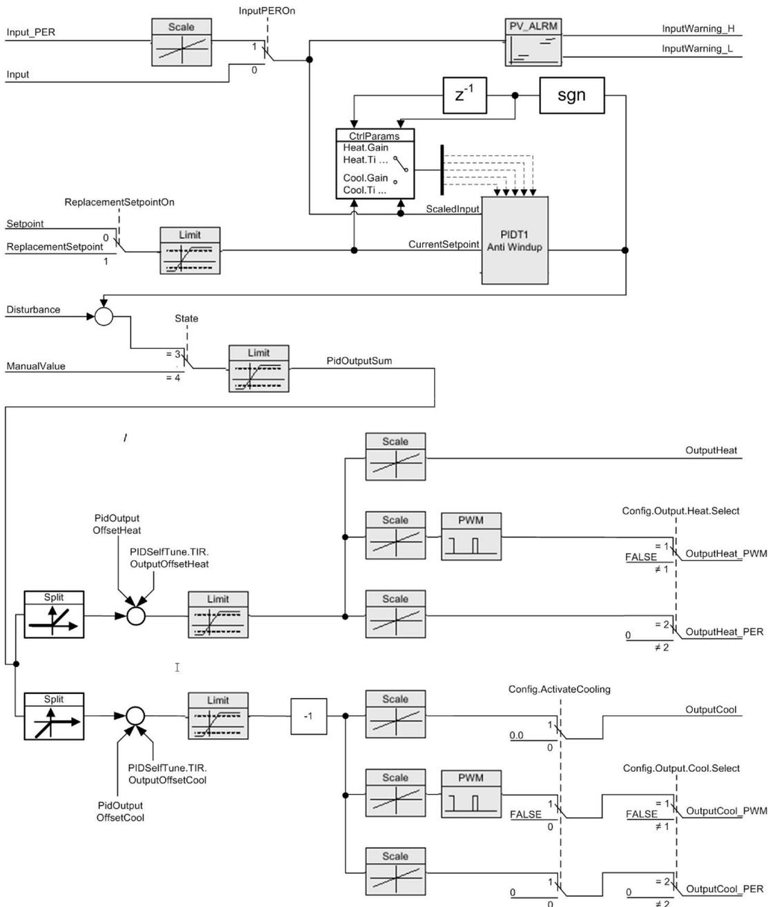
Figura 10-6 PID\_Temp\_Operation\_Block\_Diagram
