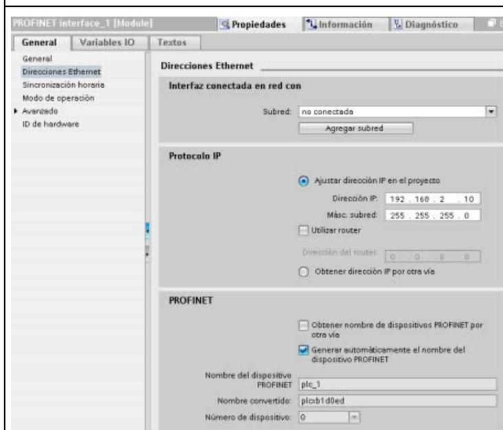
En la ventana de propiedades, seleccione la entrada de configuración "Direcciones Ethernet". STEP 7 muestra el cuadro de diálogo de configuración de direcciones Ethernet, en el que el proyecto de software se asocia a la dirección IP de la CPU que lo recibirá.
