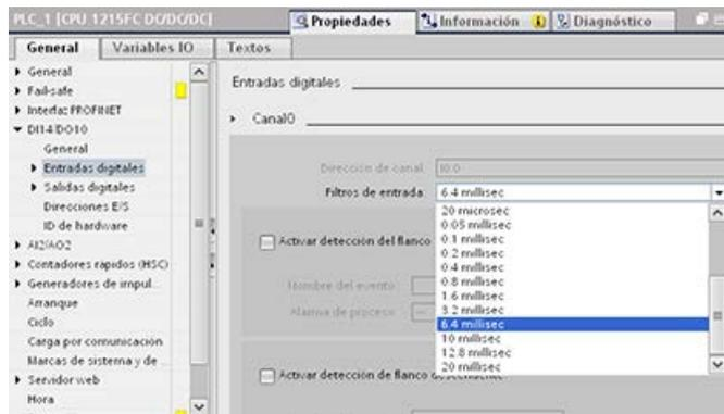
Cada entrada tiene una sola configuración de filtro, aplicable a todos los usos: entradas de proceso, interrupciones, captura de impulsos y entradas de HSC. Para configurar los tiempos de filtro de entrada, seleccione "Entradas digitales".
