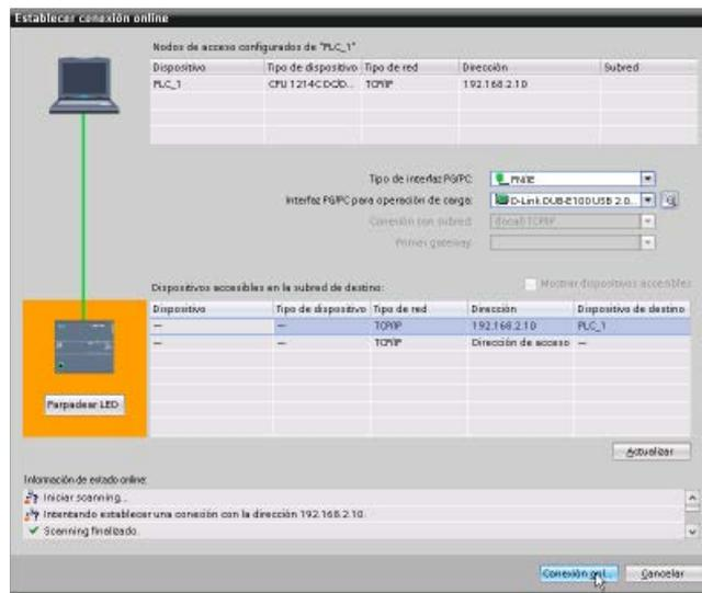
Si es la primera vez que se realiza una conexión online con esta CPU, hay que seleccionar el tipo de interfaz PG/PC y la interfaz específica PG/PC en el cuadro de diálogo Establecer conexión online antes de establecer una conexión online a una CPU detectada en dicha interfaz.
