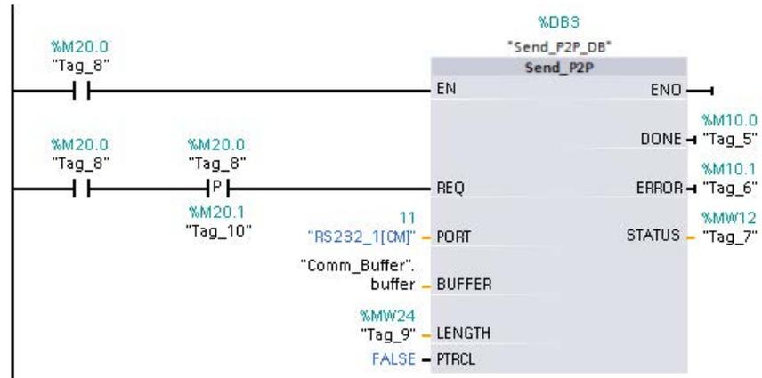
**Segmento 4:** vigile la salida DONE de SEND\_PTP y desactive la marca de transmisión (Tag\_8 en M20.0) cuando la transmisión haya finalizado. Cuando se desactiva la marca de transmisión, la instrucción RCV\_PTP en el segmento 1 es habilitada para recibir el siguiente mensaje.
