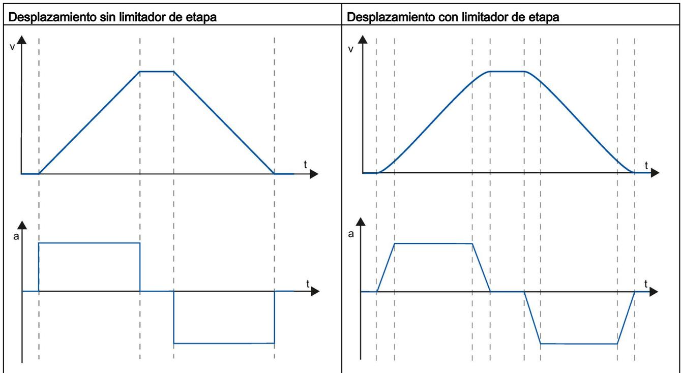
La limitación de etapa consigue un perfil de velocidad "suavizado" del movimiento del eje. De este modo se garantiza el arranque y frenado suaves de una cinta transportadora, por ejemplo.
