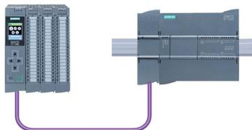
El S7-1200 se conecta a una red PROFIBUS como maestro DP con el módulo de comunicación CM 1243-5. El módulo CM 1243-5 (maestro DP) puede ser el interlocutor de esclavos DP V0/V1. En la figura inferior, el S7-1200 es un maestro que controla un esclavo DP ET 200SP:
