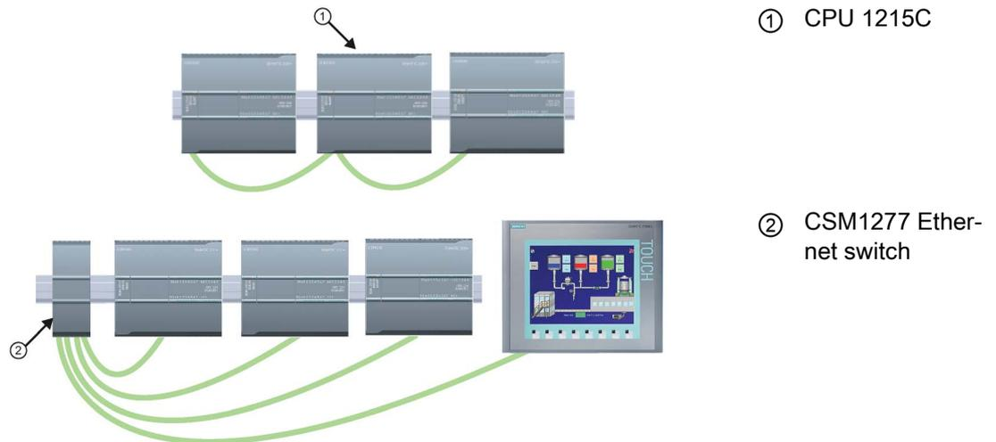
La CPU 1215C y la CPU 1217C cuentan con un switch Ethernet de 2 puertos incorporado. Se puede tener una red con una CPU 1215C y otras dos CPU S7-1200. También puede utilizarse el switch Ethernet de 4 puertos CSM1277 de montaje en rack para conectar varias CPU y dispositivos HMI.
