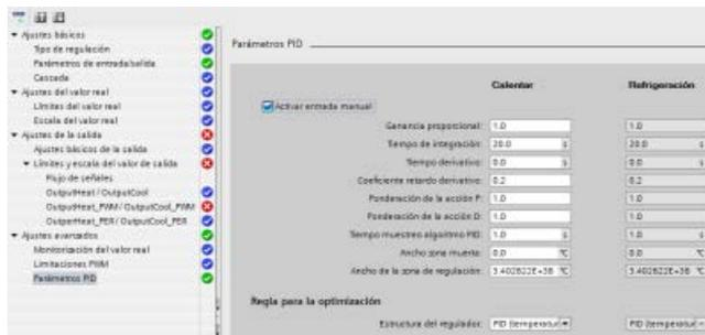
Ahora puede cambiar el valor de cualquier parámetro de configuración del regulador PID como muestra la figura inferior.
