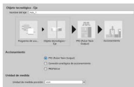
Después de crear el objeto tecnológico para el eje, se configura el eje definiendo los parámetros básicos, como el PTO y la configuración de la interfaz del accionamiento. También se configuran las demás propiedades del eje, como los límites de posición, las animaciones y la referenciación.
