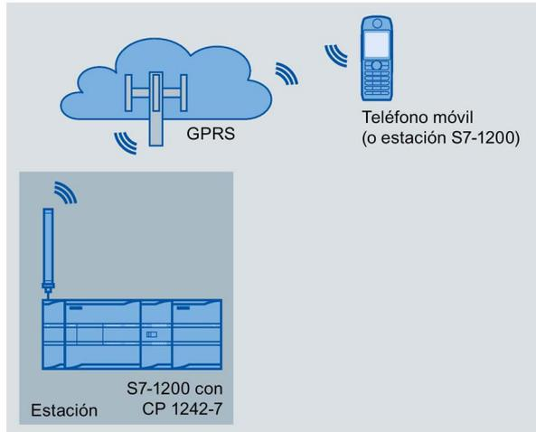
Un SIMATIC S7-1200 con un CP 1242-7 puede enviar mensajes por SMS a un teléfono móvil o a una estación S7-1200 configurada.
