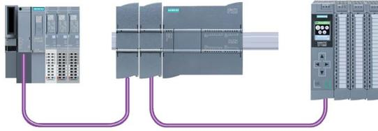
A partir de V3.0 se pueden configurar tres CM PROFIBUS como máximo por estación, pudiendo haber cualquier combinación de CM maestros DP o esclavos DP. Los maestros DP en una implementación de firmware de CPU V3.0 o superior pueden controlar un máximo de 32 esclavos.
