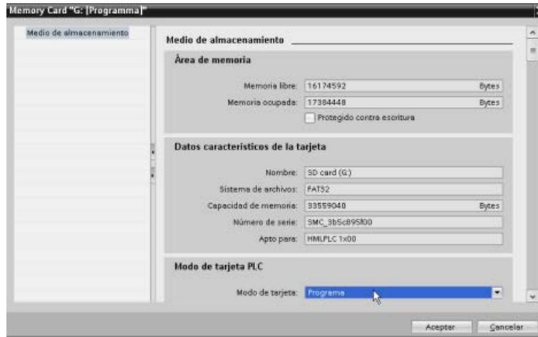
5. Agregue el programa seleccionando la CPU (p. ej. PLC\_1 [CPU 1214C DC/DC/DC]) en el árbol del proyecto y arrastrándola hasta la Memory Card. (Como alternativa, copie la CPU e insértela en la Memory Card.) Cuando la CPU se copia en la Memory Card se abre el diálogo "Cargar vista preliminar".
