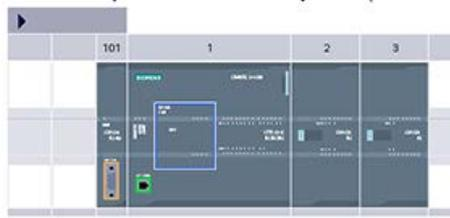
Al agregar una CPU y módulos E/S a la configuración del dispositivo, STEP 7 asigna automáticamente direcciones de entrada y salida. El direccionamiento predeterminado puede cambiarse seleccionando el campo de dirección en la configuración de dispositivos e introduciendo números nuevos.
