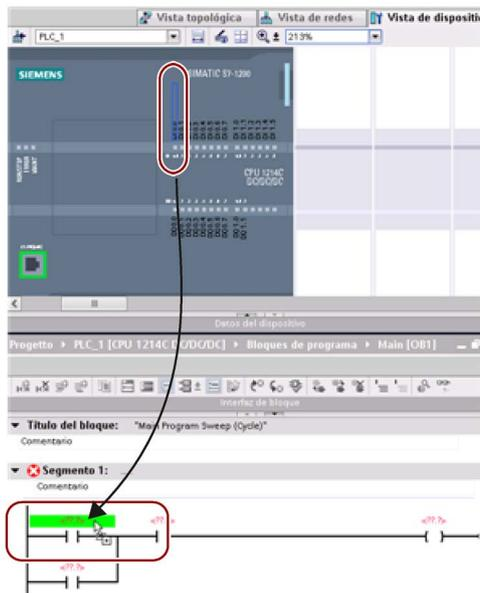
Para ayudar a realizar las tareas rápida y fácilmente, STEP 7 permite arrastrar y soltar elementos de un editor a otro. Así, es posible, por ejemplo, arrastrar una entrada de la CPU a la dirección de una instrucción del programa de usuario.
