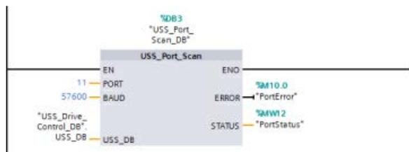
**Segmento 1** El estado del puerto "PortStatus" y los valores de los códigos de error avanzados de "USS\_Drive\_Control\_DB".USS\_Extended\_Error solo son válidos durante un ciclo del programa. Los valores deben capturarse para un procesamiento posterior.
