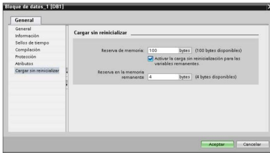
La función "Carga sin reinicialización" permite extender un bloque de datos añadiendo más variables de bloques de datos y cargar el bloque de datos extendido en estado operativo RUN. De este modo, puede añadir variables al bloque de datos y cargarlo sin reinicializar el programa. La CPU retiene los valores de las variables de bloques de datos existentes e inicializa las variables añadidas recientemente a sus valores de arranque.
