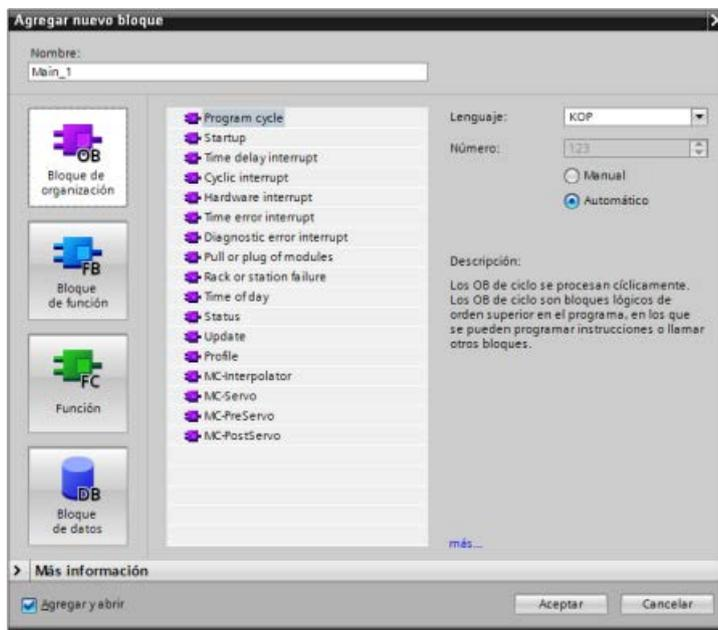
El procesamiento de alarmas siempre está controlado por eventos. Cuando ocurre un evento, la CPU interrumpe la ejecución del programa de usuario y llama el OB configurado para procesar ese evento. Una vez finalizada la ejecución del OB de alarma, la CPU reanuda la ejecución del programa de usuario en el punto de interrupción.
