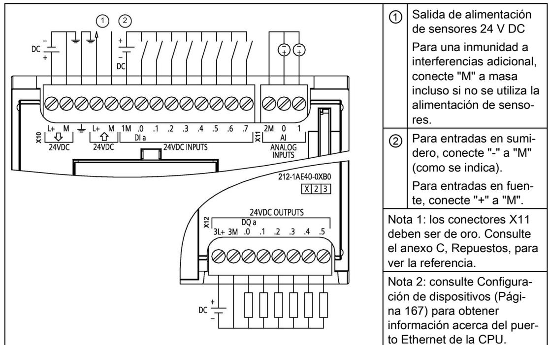
① Salida de alimentación de sensores 24 V DC
