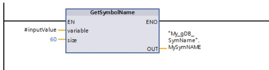
Interconecte el parámetro inputValue del bloque Level1 del siguiente modo.
