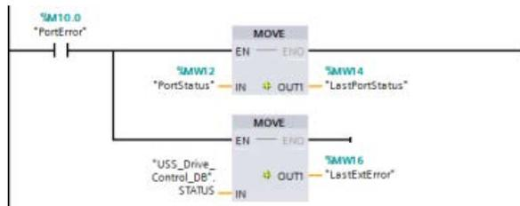
**Segmento 2** El contacto "PortError" inicia el almacenamiento del valor "PortStatus" en "LastPortStatus" y del valor "USS\_Drive\_Control\_DB".USS\_Extended\_Error en "LastExtError".
