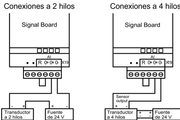
Tabla A- 209 Diagrama de cableado de la SB de entrada analógica
