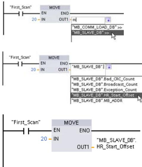
Introducir una variable de esclavo Modbus utilizando el nombre de DB predeterminado:
