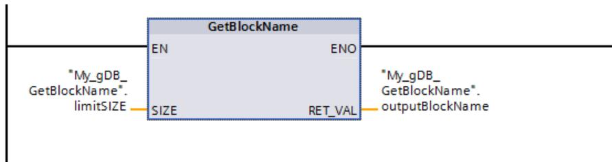
El bloque Level1\_gbn ejecuta la instrucción GetBlockName. GetBlockName lee el nombre del bloque Level1\_gbn y emite el nombre en forma de cadena de caracteres en el parámetro de salida RET\_VAL (outputBlockName). Puesto que el parámetro SIZE es 0 (limitSIZE), la longitud de la cadena de caracteres es ilimitada.
