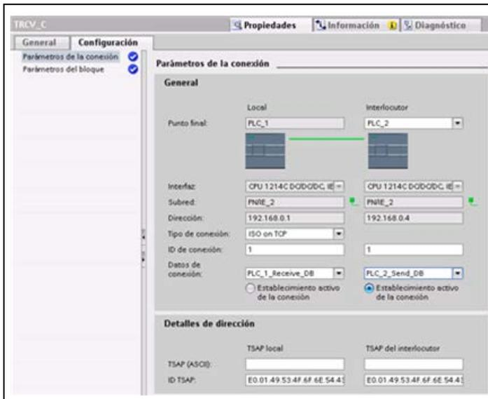
Para los protocolos de Ethernet TCP, ISO on TCP y UDP, utilice las "Propiedades" de la instrucción (TSEND\_C, TRCV\_C o TCON) para configurar las conexiones "local/interlocutor".
