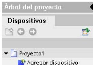
En la lista, asegúrese de insertar el modelo y la versión de firmware correctos. Al seleccionar la CPU en el diálogo "Agregar nuevo dispositivo" se crean el rack y la CPU.
