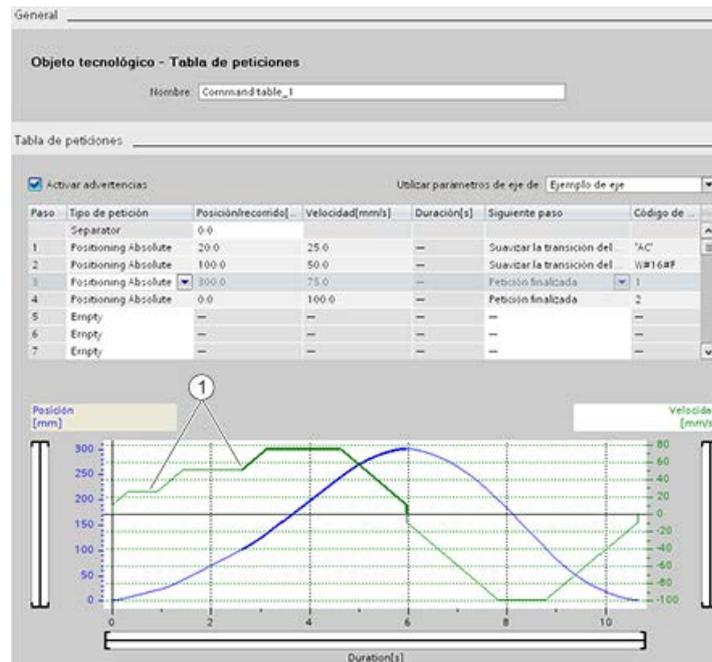
① El eje sigue moviéndose y acelera o decelera a la velocidad del siguiente paso, ahorrando tiempo y desgaste mecánico.
