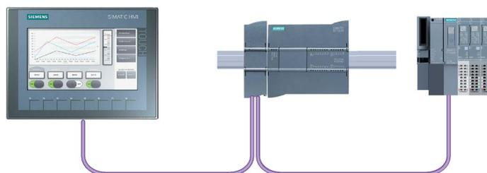
Si un CM 1242-5 y un CM 1243-5 están instalados conjuntamente, un S7-1200 puede actuar simultáneamente tanto de un esclavo de un sistema maestro DP de nivel superior como de maestro de un sistema esclavo DP subordinado:
