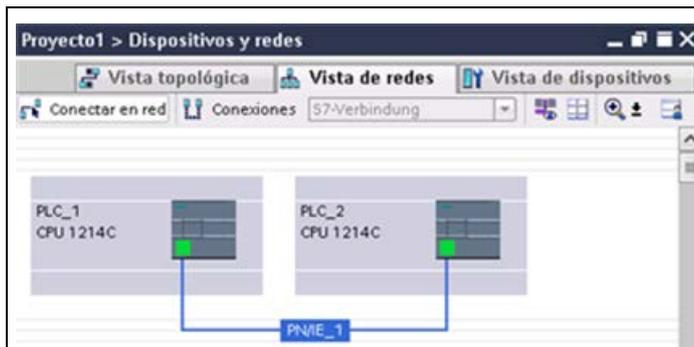
Utilice la "Vista de red" de la "Configuración de dispositivos" para crear las conexiones de red entre los dispositivos del proyecto. Tras crear la conexión de red, utilice la ficha "Propiedades" de la ventana de inspección para configurar los parámetros de la red.
