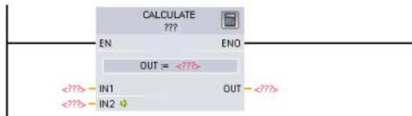
La instrucción Calculate no configurada ofrece dos parámetros de entrada y uno de salida.
