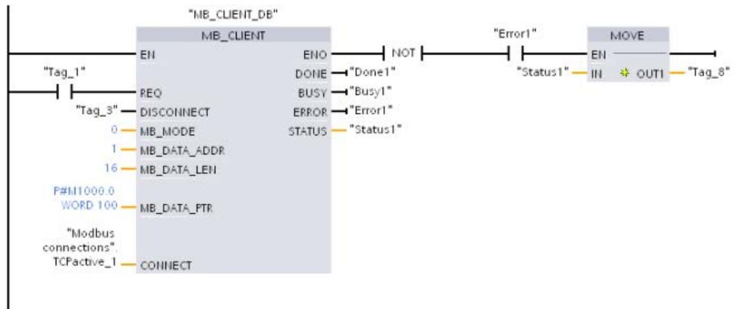
**Segmento 2:** Función Modbus 2: leer 32 bits de entrada de un servidor Modbus TCP con la dirección IP asignada en "Conexiones Modbus".TCPactiva\_1.
