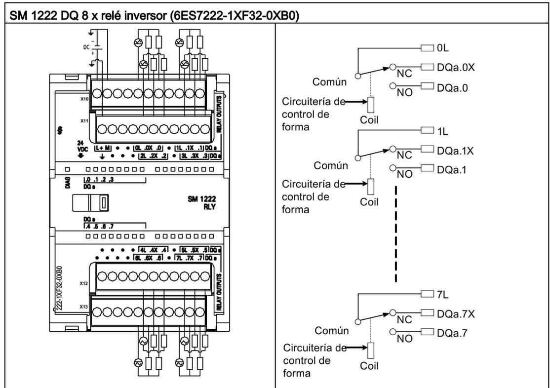
Una salida de relé inversor controla dos circuitos mediante un borne común: un contacto normalmente cerrado y un contacto normalmente abierto. Si usamos "0" a modo de ejemplo, cuando la salida está desactivada, el (0L) común está conectado a un contacto normalmente cerrado (.0X) y está desconectado del contacto normalmente abierto (.0). Cuando la salida está activada, el (0L) común está desconectado del contacto normalmente cerrado (.0X) y está conectado al contacto normalmente abierto (.0).
