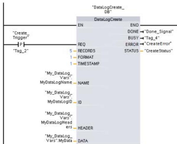
**Segmento 2** Capturar la salida DONE de DataLogCreate porque solo es válida durante un ciclo.
