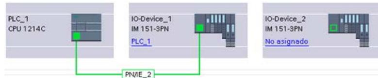
Cuando se descargan las nuevas conexiones de red, la CPU debe estar en modo STOP.
