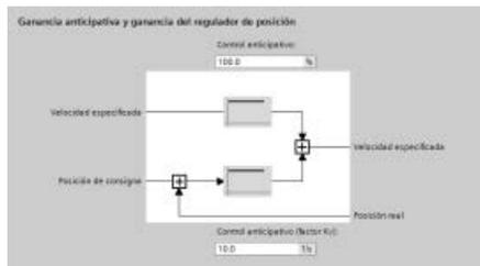
"Lazo de regulación": Se puede configurar la ganancia de velocidad conocida como "Control previo (factor Kv)".
