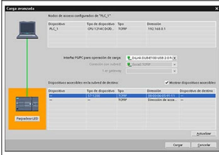
Tras finalizar la configuración, cargue el proyecto en la CPU. Todas las direcciones IP se configuran al cargar el proyecto en el dispositivo.
