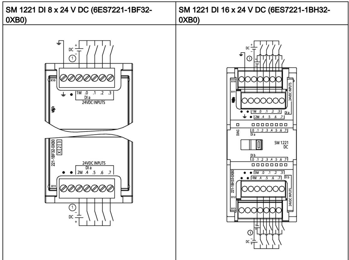
① Para entradas en sumidero, conecte "-" a "M" (como se indica). Para entradas en fuente, conecte "+" a "M".
