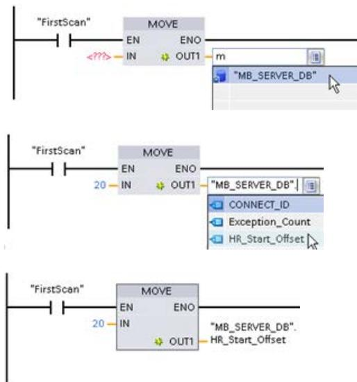
Introducir una variable de servidor Modbus utilizando el nombre de DB predeterminado:
