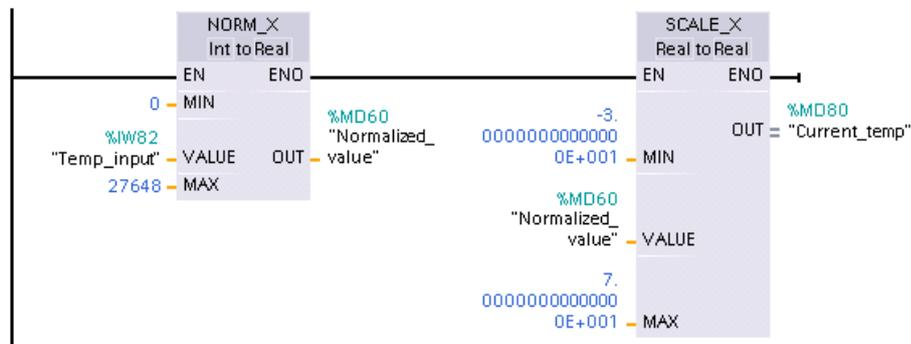
Recuerde que si la entrada analógica provenía de un módulo de señales analógicas o una Signal Board con tensión, el valor MIN para la instrucción NORM\_X sería -27648 en lugar de 0.
