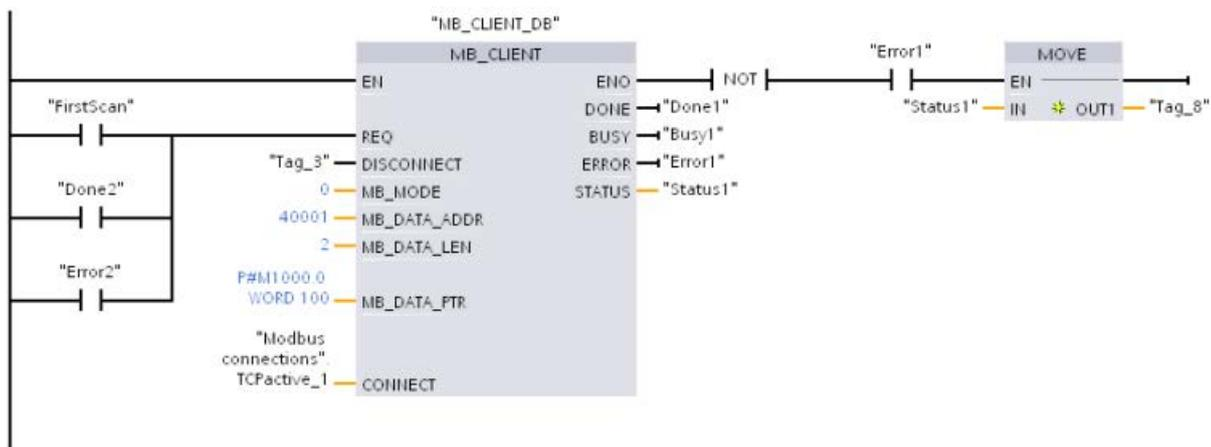
**Segmento 2:** Función Modbus 3: leer palabras de registro de retención del servidor Modbus TCP
