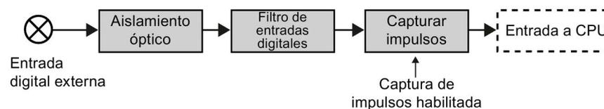
La figura siguiente muestra la reacción de una función de captura de impulsos a diversas condiciones de entrada. Si en un ciclo dado se presenta más de un impulso, se lee solo el primer impulso. Si se presentan varios impulsos en un ciclo, se recomienda utilizar los eventos de interrupción de flanco ascendente/descendente:
