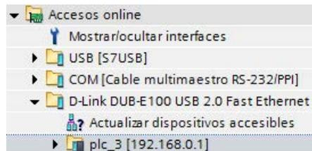
4. Desde el menú "Online" de STEP 7 seleccione el comando "Carga del dispositivo como estación nueva (hardware y software)".
