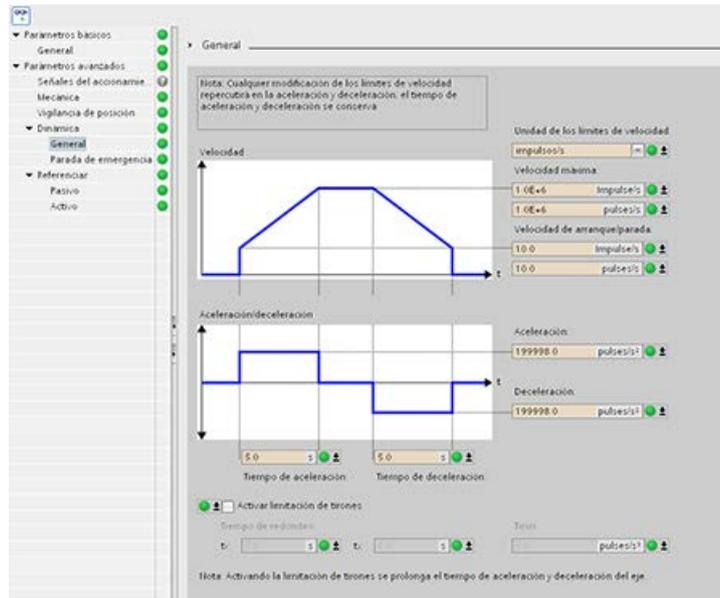
Ahora puede cambiar el valor de cualquiera de los parámetros de configuración de Motion Control de la forma representada en la figura inferior.
