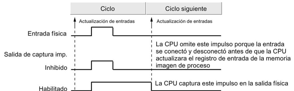
Puesto que la captura de impulsos opera en la entrada después de que pase por el filtro, es preciso ajustar el tiempo de filtración de las entradas de manera que el filtro no suprima el impulso. La figura siguiente muestra un diagrama de bloques de una entrada digital:
