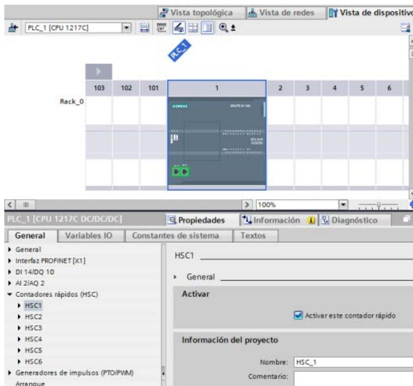
Después de activar el HSC, STEP 7 establece el contaje de fase simple como configuración predeterminada. Una vez se ha establecido el filtro de entrada digital para la entrada de reloj del HSC, es posible descargar el programa en el PLC y entonces la CPU ya estará lista para contar. Para modificar la configuración del HSC, consulte el apartado siguiente "Tipo de contaje".
