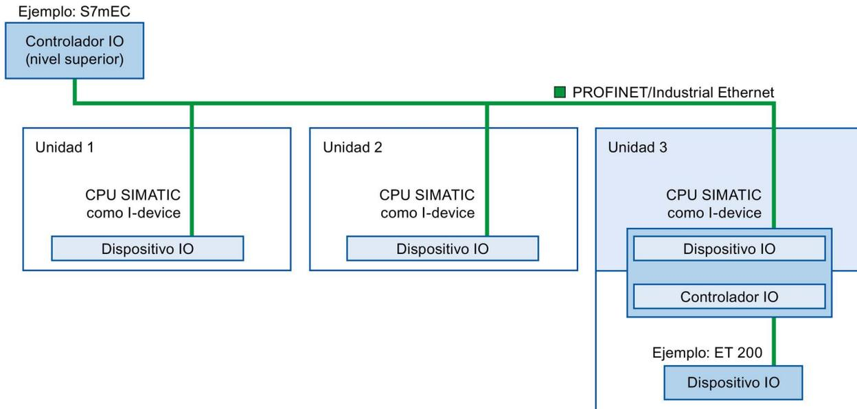
La unidad 1 y la unidad 2 constan de un I-device con E/S centralizadas. El I-device junto con el sistema de E/S descentralizadas (por ejemplo, ET 200) forma la unidad 3.
