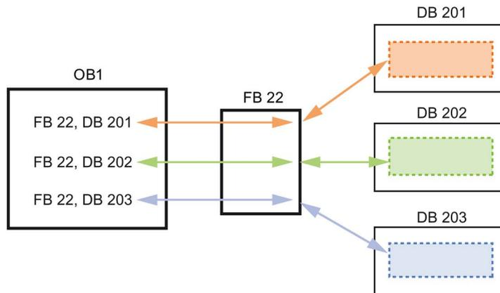
En este ejemplo, el FB 22 controla tres dispositivos diferentes. El DB 201 almacena los datos operativos del primer dispositivo, el DB 202, los del segundo y, el DB 203, los del tercero.
