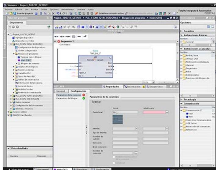
La ventana de inspección muestra las propiedades de la conexión cuando se selecciona cualquier parte de la instrucción. Los parámetros de comunicación se configuran en la ficha "Configuración" de "Propiedades" de la instrucción de comunicación.
