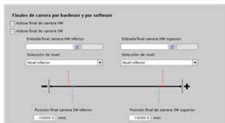
**Límites de posición:** Se pueden configurar las propiedades de las señales y los mecanismos del accionamiento, así como la vigilancia de posición (finales de carrera por hardware y software).
