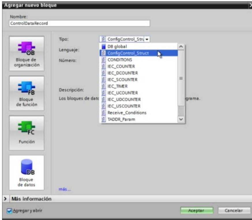
6. En este bloque de datos configure Block\_length, Block\_ID, versión y subversión tal y como se muestra abajo. Configure los valores para los slots sobre la base de su presencia o ausencia y posición en la instalación real:
