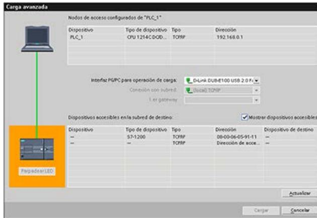
Si el dispositivo de red deseado no se encuentra en esta lista, la comunicación con ese dispositivo se habrá interrumpido por algún motivo. En este caso es preciso examinar el dispositivo y la red para buscar errores de hardware y/o configuración.
