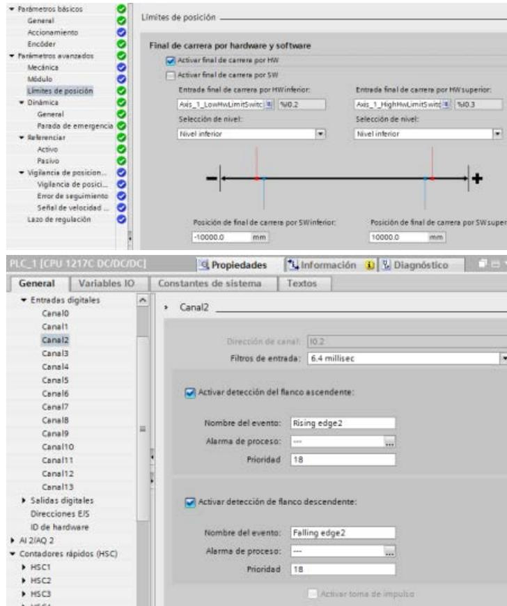
2. Se ha cambiado un "final de carrera por hardware con entrada low" a I0.6 y se confirma. Se muestra el cuadro de diálogo para la detección de flancos. Se selecciona: "Cancelar":
