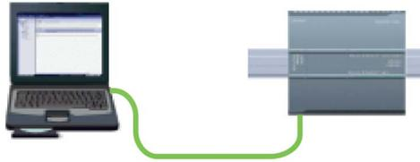
Una CPU puede comunicarse con una programadora con STEP 7 en una red.
