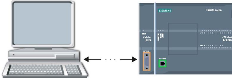
Hay que conectar la interfaz de comunicación del módulo CM 1241 RS232 a la interfaz RS232 del PC, que por lo general es COM1. Debido a que estos dos puertos son equipos terminales de datos (Data Terminal Equipment DTE), hay que intercambiar los pines de recepción y transmisión (2 y 3) al conectar ambos puertos. Esto se puede realizar aplicando uno de los métodos siguientes:
