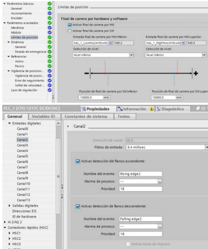
2. Se ha cambiado un "final de carrera por hardware con entrada low" a I0.6 y se confirma. Se muestra el cuadro de diálogo para la detección de flancos. Se selecciona: "No: cambiar la dirección y mantener la detección de flancos en la dirección antigua.":
