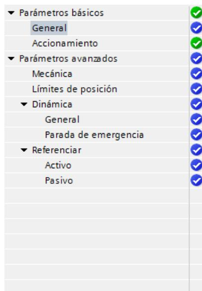
El selector de árbol del eje PTO no incluye los menús de configuración Encóder, Módulo, Vigilancia de posicionamiento y Lazo de regulación.
