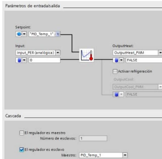
Segmento 1: En estos segmentos se establece la conexión entre el maestro "PID\_Temp\_1" y el esclavo "PID\_Temp\_2" en el editor de programación:
