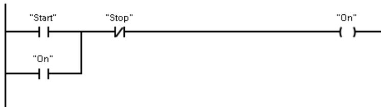
Para crear la lógica de operaciones complejas, es posible insertar ramas para los circuitos paralelos. Las ramas paralelas se abren hacia abajo o se conectan directamente a la barra de alimentación. Las ramas se terminan hacia arriba.
