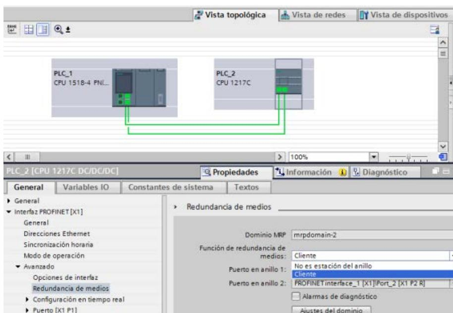
4. En "Función de redundancia de medios", asigne al dispositivo la función "Manager (Auto)", "Cliente" o "No es estación del anillo".
