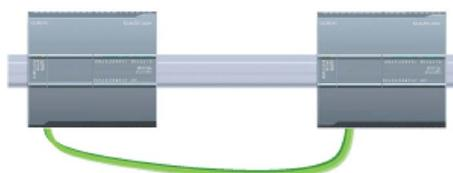
Una CPU puede comunicarse con otra CPU utilizando las instrucciones TSEND\_C y TRCV\_C.
