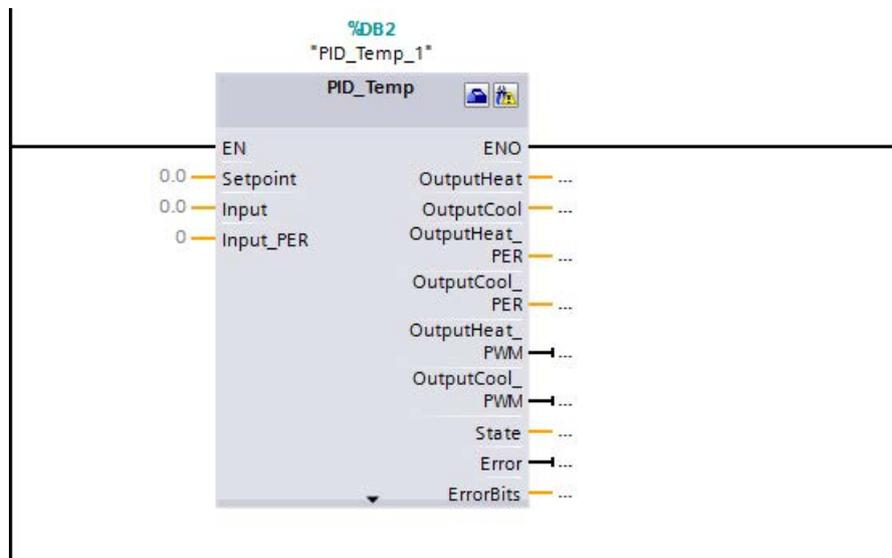
Segmento 2: Se establece la conexión entre los parámetros "OutputHeat" y "slave" del maestro "PID\_Temp\_1" y los parámetros "Setpoint" y "Master" del esclavo "PID\_Temp\_2" respectivamente:
