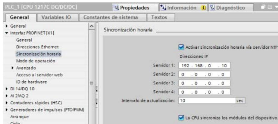
En el ajuste predeterminado no están activadas ni la sincronización horaria con el servidor NTP ni la sincronización horaria de los relojes de CP con el reloj de la CPU.
