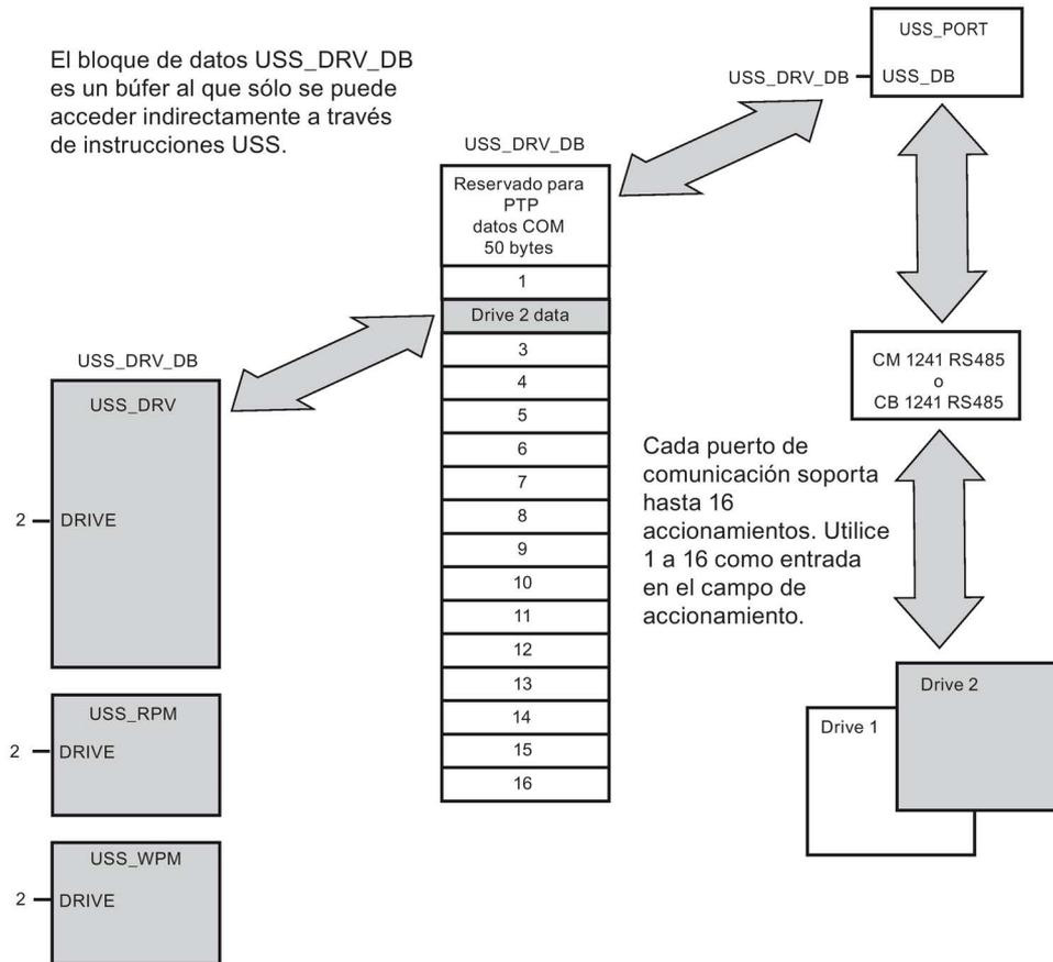
Todos los accionamientos (máx. 16) conectados a un solo puerto RS485 pertenecen a una misma red USS. Todos los accionamientos conectados a otro puerto RS485 pertenecen a diferentes redes USS. Cada red USS se gestiona utilizando un bloque de datos unívoco. Todas las instrucciones asociadas a una red USS deben compartir dicho bloque de datos. Esto incluye todas las instrucciones USS\_DRV, USS\_PORT, USS\_RPM y USS\_WPM utilizadas para controlar todos los accionamientos de una red USS.
