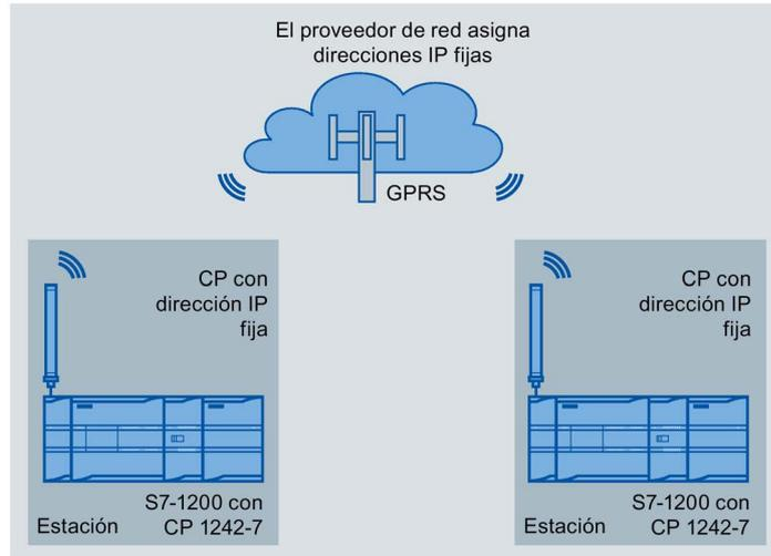
Figura 13-2 Comunicación directa entre dos estaciones S7-1200
