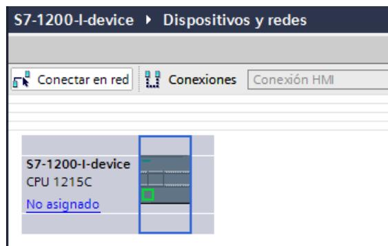
4. Haga doble clic en el dispositivo IO y configure todos los módulos y submódulos necesarios.
