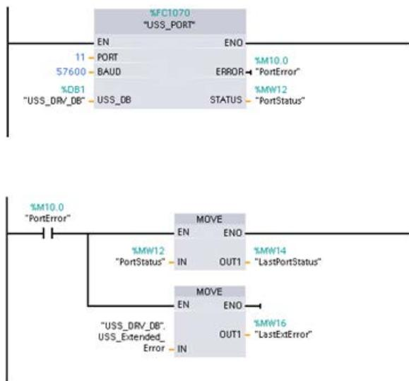
**Segmento 1** El estado del puerto "PortStatus" y los valores de los códigos de error avanzados de "USS\_DRV\_DB".USS\_Extended\_Error solo son válidos durante un ciclo del programa. Los valores deben capturarse para un procesamiento posterior.
