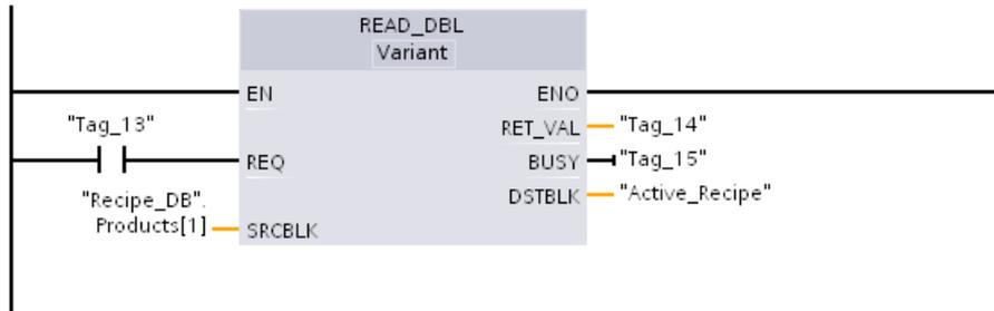
**Segmento 6** Durante el tiempo de ejecución, un dispositivo HMI puede modificar un valor de componente almacenado en DB Active\_Recipe. Los datos mejorados de la receta pueden almacenarse ejecutando WRIT\_DBL. En el ejemplo, todos los valores de arranque de Recipe\_DB para la receta individual "Recipe\_DB". Los productos[1] se sobrescriben con los valores actuales del DB "Active\_Recipe".
