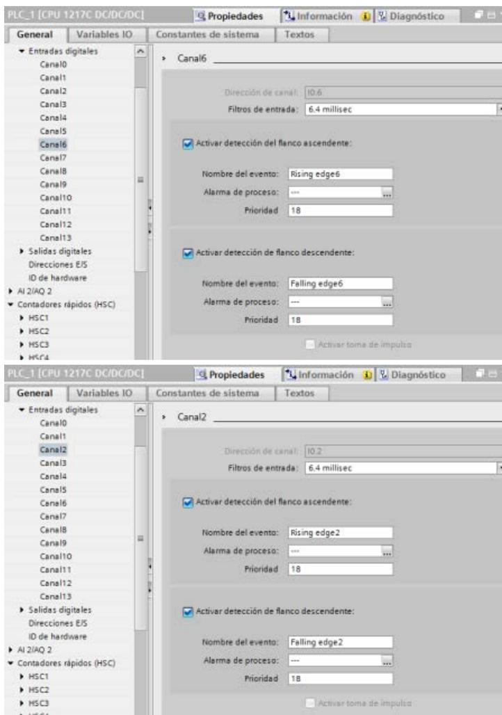
**Ejemplo: Cancelar el cambio a una nueva dirección de final de carrera por hardware con detección de flancos**
