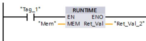
Cuando el operando "Tag\_1" del segmento 1 tiene el estado lógico "1", se ejecuta la instrucción RUNTIME. El punto de inicio para la medición del tiempo de ejecución se define con la primera llamada de la instrucción y se respalda como referencia para la segunda llamada de la instrucción en el operando "Mem".
