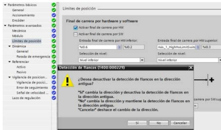
3. El "interruptor de final de carrera por hardware con entrada low" se mantiene configurado en I0.2 y la detección de flancos en I0.2 se mantiene activada:
