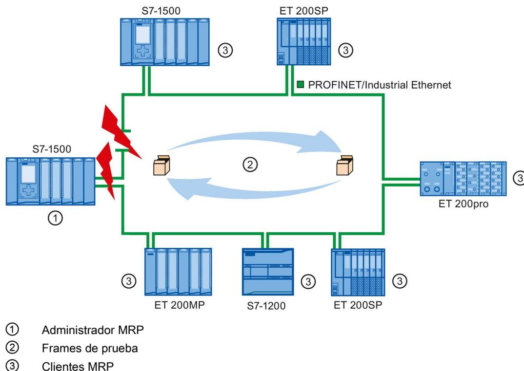
Los puertos en anillo de un dispositivo son los que establecen la conexión con los dos dispositivos vecinos en la topología en anillo. Los puertos en anillo se seleccionan y ajustan en la configuración del dispositivo en cuestión (dado el caso está predefinido).
