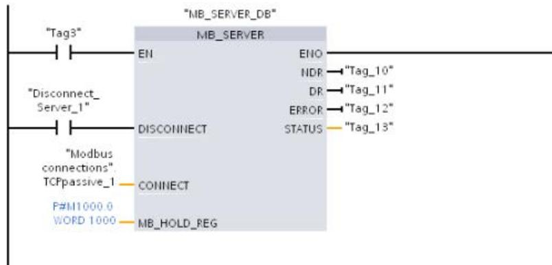
**Segmento 2:** Conexión n.º 2, DB de instancia= "MB\_SERVER\_DB\_1", en "Conexiones Modbus.TCPpasiva\_2" (ID = 2 y LocalPort = 503)
