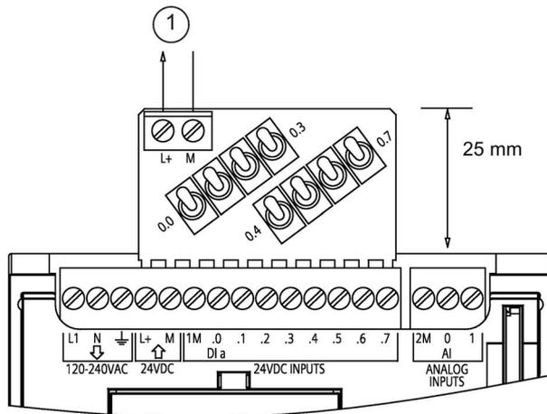
① Salida de alimentación de sensores 24 V DC
