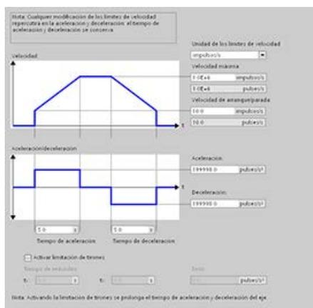
**Dinámica:** Se pueden configurar las animaciones del movimiento y el comportamiento del comando de parada de emergencia.
