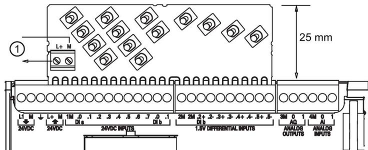
① Salida de alimentación de sensores 24 V DC
