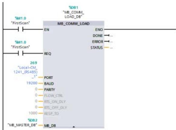
Una instrucción MB\_MASTER se usa en el OB del ciclo de programa para comunicar con un solo esclavo. Se pueden usar más instrucciones MB\_MASTER en el OB del ciclo de programa para comunicar con otros esclavos o se puede reutilizar un FB MB\_MASTER para comunicar con más esclavos.
