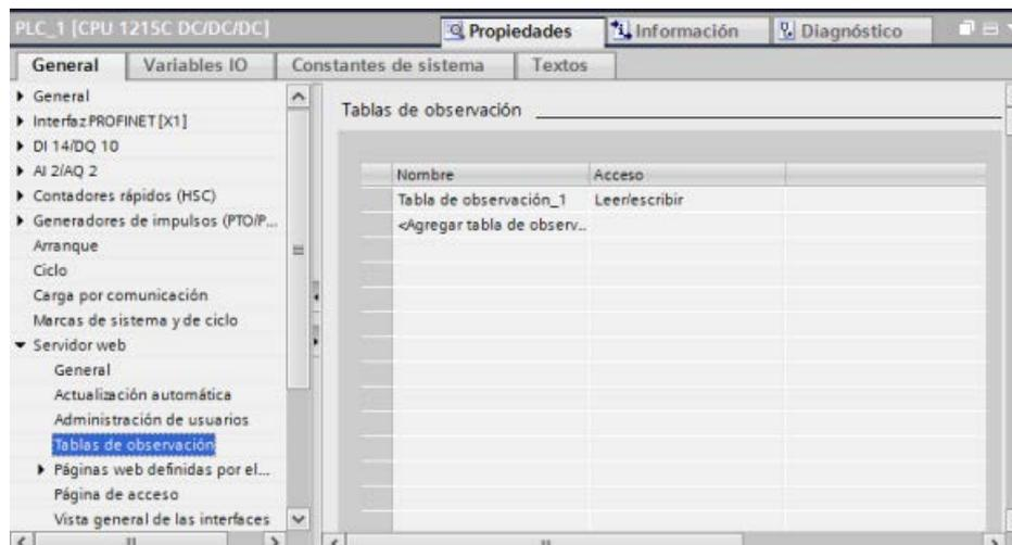
Una vez finalizada la configuración de tablas de observación en la sección de configuración de dispositivos del servidor web, descargue la configuración hardware en la CPU.
