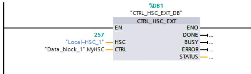
Una vez se ha configurado el HSC en el PLC ya puede ejecutarse la instrucción `CTRL_HSC_EXT`. Si se produce un error, ENO se pone a "0" y la salida STATUS indica el código de condición.
