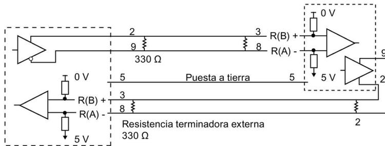
**Caso 2: RS422 sin detección de rotura de cable, polarización directa**
