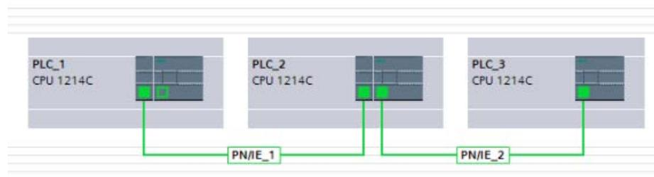
Con el fin de comprobar el routing de una subred S7 a otra, el PLC\_1 debe establecer una conexión de transporte con el PLC\_3 y este debe establecer una conexión con el PLC\_1. De este modo se garantiza que son posibles tanto el routing de la interfaz PN/IE del PLC a un módulo CP como de un módulo CP a la interfaz PN/IE del PLC.
