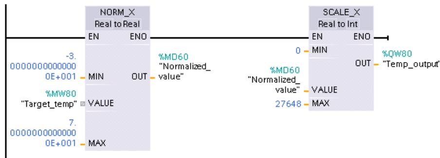
Recuerde que si la salida analógica estaba destinada a un módulo de señales analógicas o una Signal Board con tensión, el valor MIN para la instrucción SCALE\_X sería -27648 en lugar de 0.
