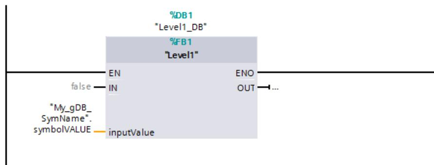
La instrucción GetSymbolName se ejecuta en el bloque Level1. La interconexión del parámetro de entrada inputValue del bloque Level1 se examina mediante el parámetro de entrada VARIABLE de la instrucción. De este modo, la variable symbolVALUE se lee y se emite como cadena de caracteres en el parámetro de salida OUT ("MySymNAME"). De acuerdo con el valor del parámetro de entrada SIZE, la longitud de la cadena de caracteres está limitada a 60 caracteres.
