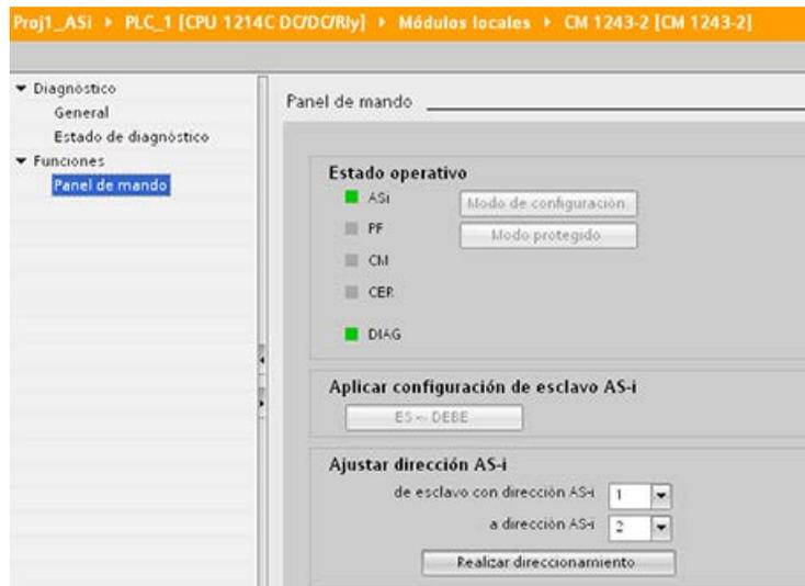
En el campo "Ajustar dirección AS-i", puede cambiar la dirección del esclavo AS-i. A un esclavo nuevo que aún no tenga dirección se le asigna siempre la dirección 0. El maestro lo reconoce como esclavo nuevo aunque no tenga asignada una dirección y no lo incluye en la comunicación normal hasta que no le sea asignada una dirección.
