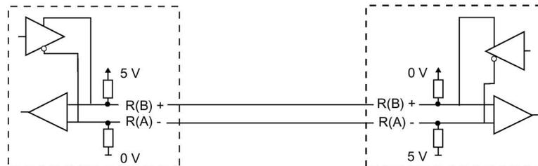
**Caso 5: RS485: Sin polarización (polarización externa)**
