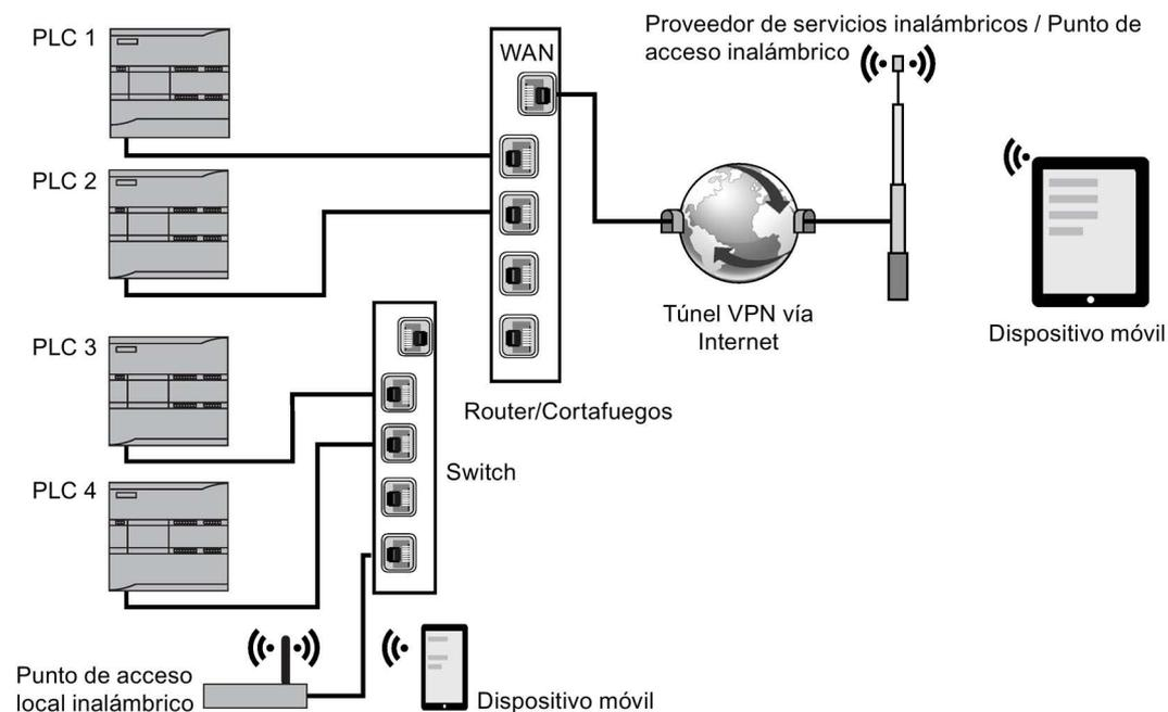
En este ejemplo, un dispositivo móvil que está dentro del alcance del punto de acceso inalámbrico puede conectarse al PLC 3 y PLC 4 a partir de sus direcciones IP. Desde Internet, fuera del alcance inalámbrico local, un dispositivo móvil puede conectarse a PLC 1 y PLC 2 con la dirección del puerto redireccionada para cada PLC.
