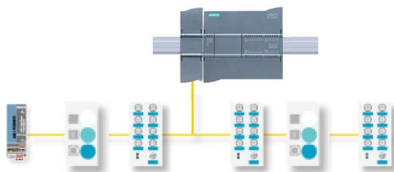
Para utilizar AS-i con CPUs S7-1200 V4.0 hay que actualizar el firmware del CM del maestro AS-i a V1.1.
