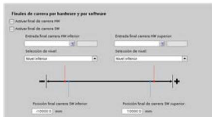
Configure las propiedades de las señales y los mecanismos del accionamiento, así como la vigilancia de posición (finales de carrera por hardware y software).
