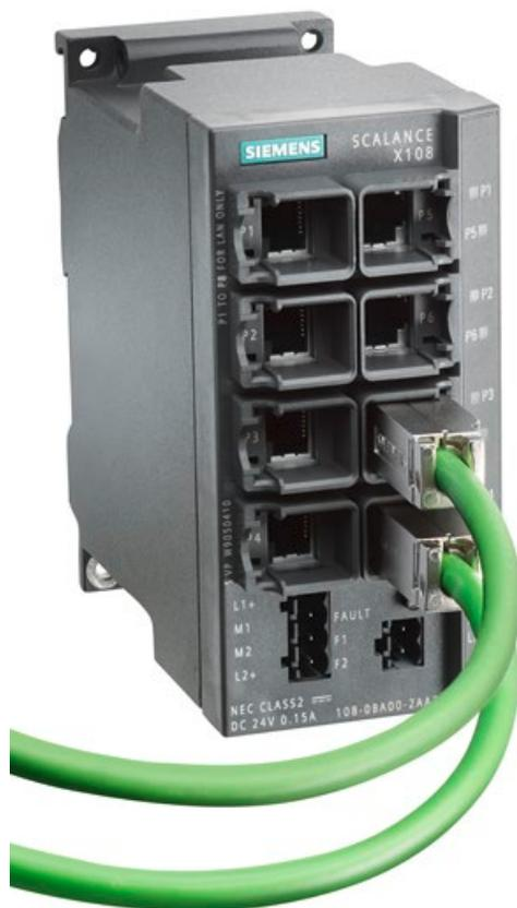
Bild 5-2 Stecken des IE FC RJ45 Plug 180
