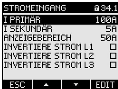
5. Im Menübefehl "ANZEIGEBEREICH" kann die Auflösung der Stromanzeige konfiguriert werden. Die Einstellung hat keinen Einfluss auf die Messgenauigkeit des Geräts. Die empfohlene Einstellung ist der üblicherweise in der Anlage fließende Strom. Beim üblichen Strom von 50 A, ist Anzeigebereich auf 50 A einzustellen. In diesem Fall wird der Strom mit einer Nachkommastelle angezeigt.
