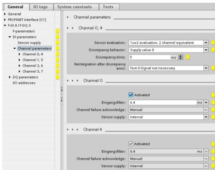
Table 6- 3 ET 200eco PN F-DI 8 / F-DQ 3 DI channel parameters
