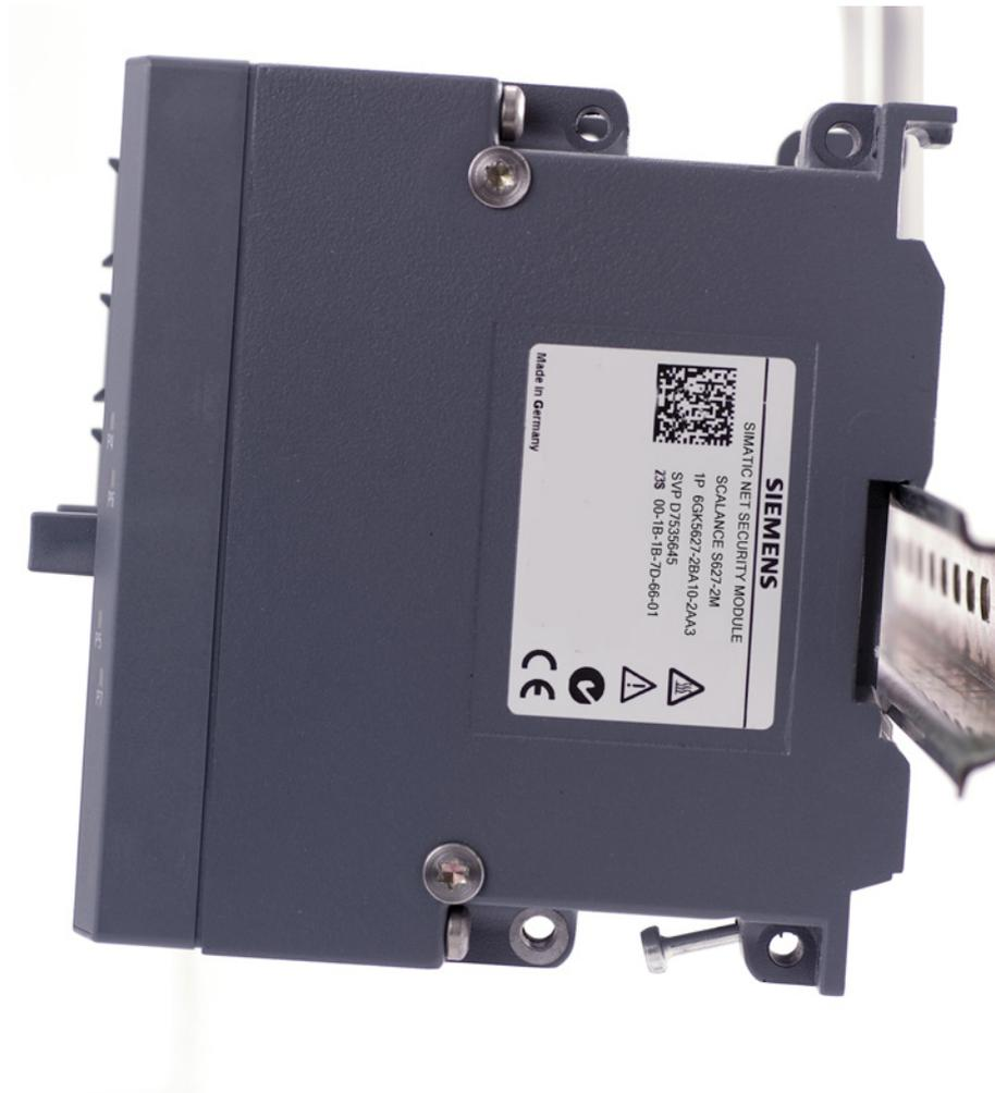
Bild 5-2 SCALANCE S Demontage von einer DIN-Hutschiene (35 mm)
