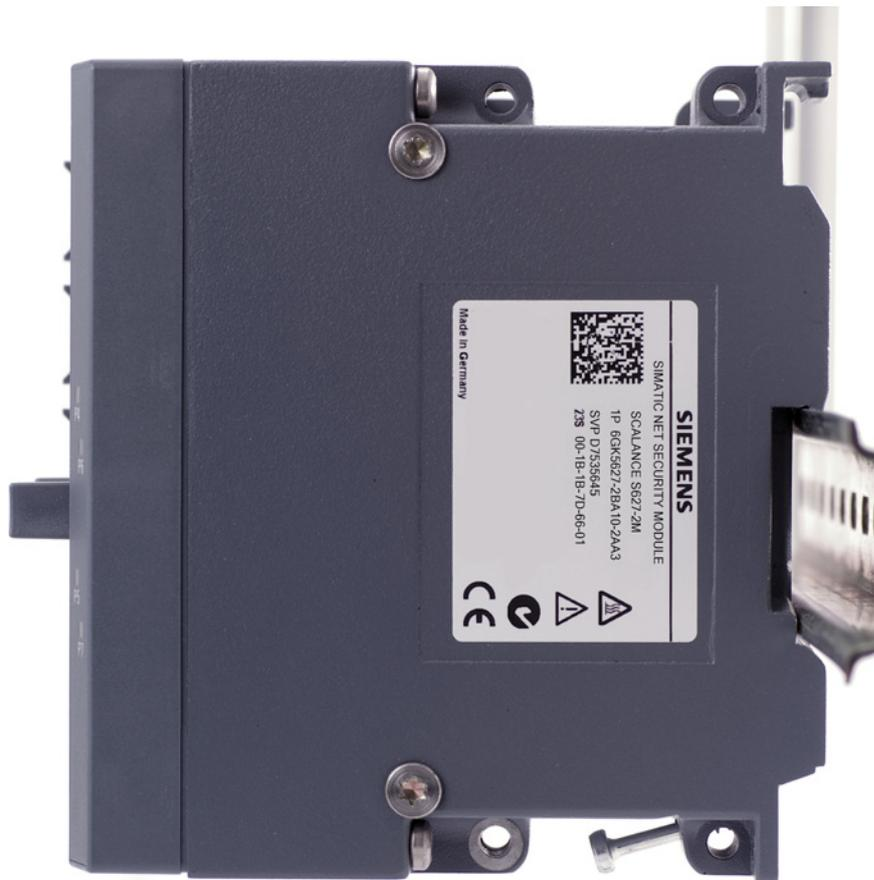
Bild 5-1 SCALANCE S Montage auf einer DIN-Hutschiene (35 mm)
