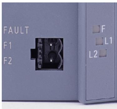
Bild 3-3 Meldekontakt bei SCALANCE S627-2M
