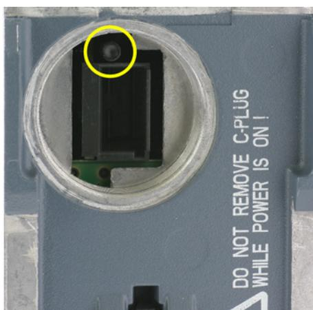
Bild 4-1 Reset-Taster und Steckplatz für den C-PLUG
