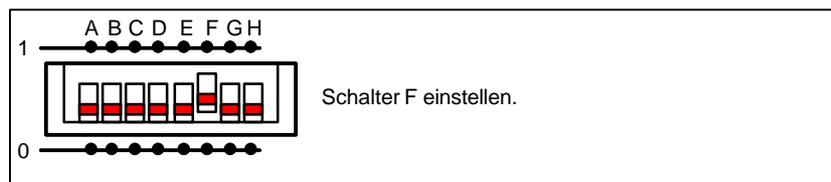
Bild 4.27 Funktionsschalter an der Rückseite des externen MOD
