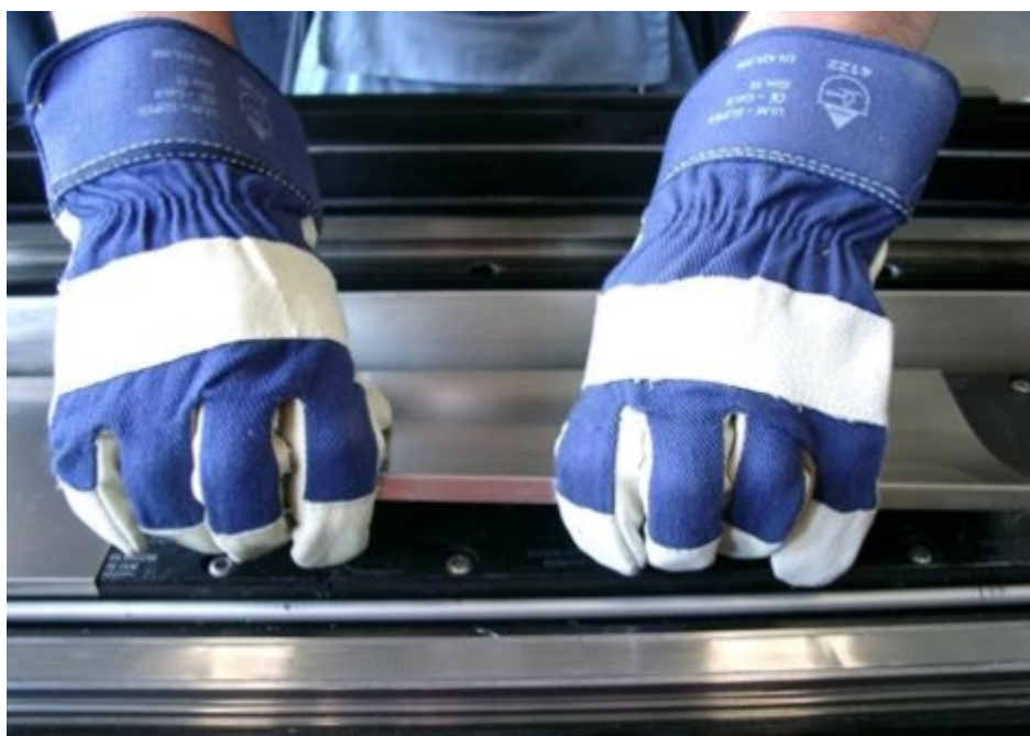
图 7-20 分段式盖板的拆卸
