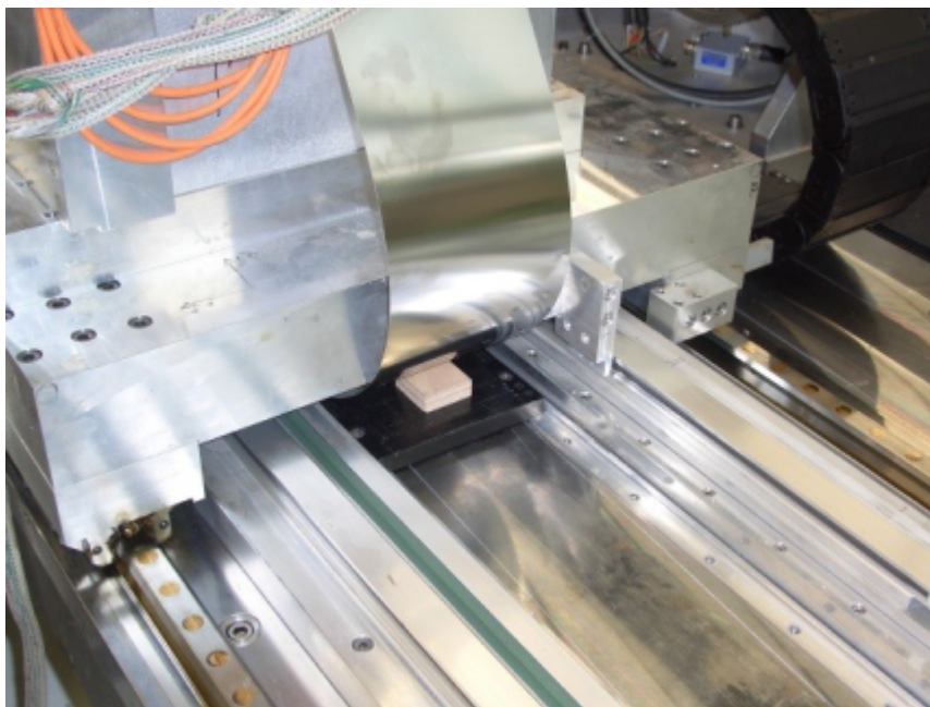
图 7-14 固定整段式盖板
