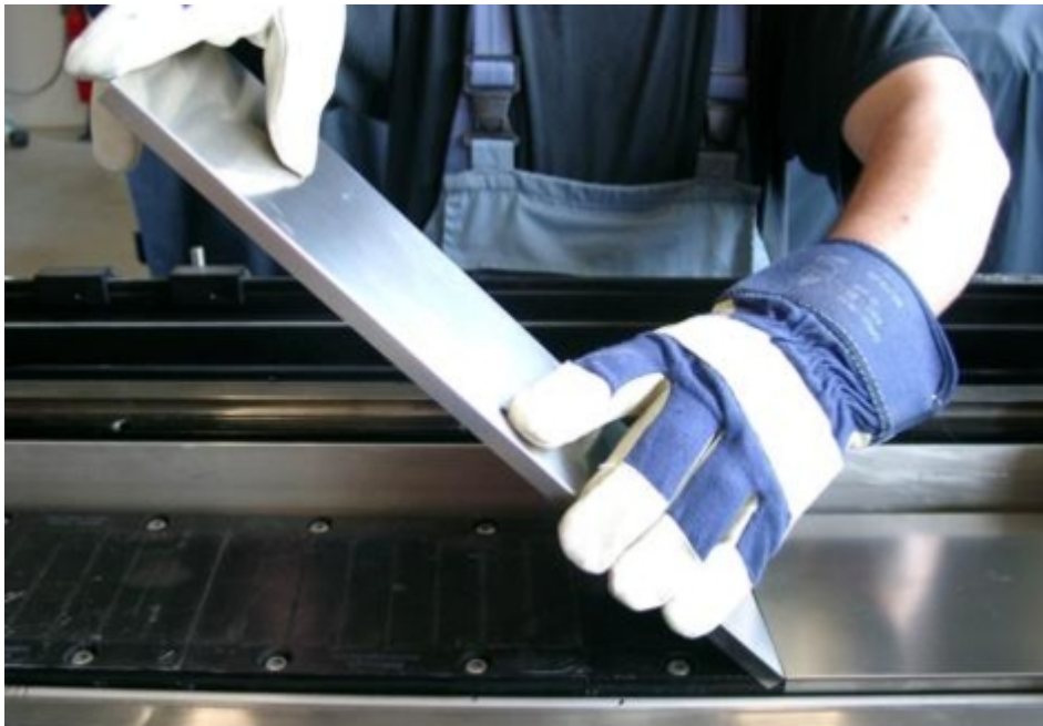
图 7-18 安装分段式盖板的其他段
