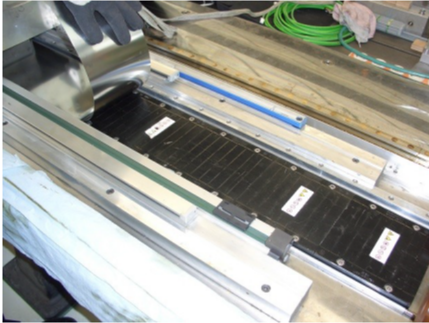
图 7-15 在次级部件上展开整段式盖板
