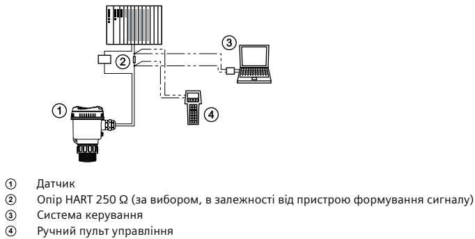
Рисунок 3.4 Під'єднання ПК до сигнальної лінії
