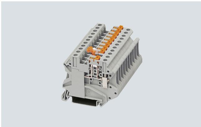
Les blocs de sectionnement à couteau 8WH se distinguent notamment par leur compacité et par un courant permanent admissible élevé de 20 A. Il est possible de les ponter avec des blocs de jonction standard via le double logement pour cavaliers.
