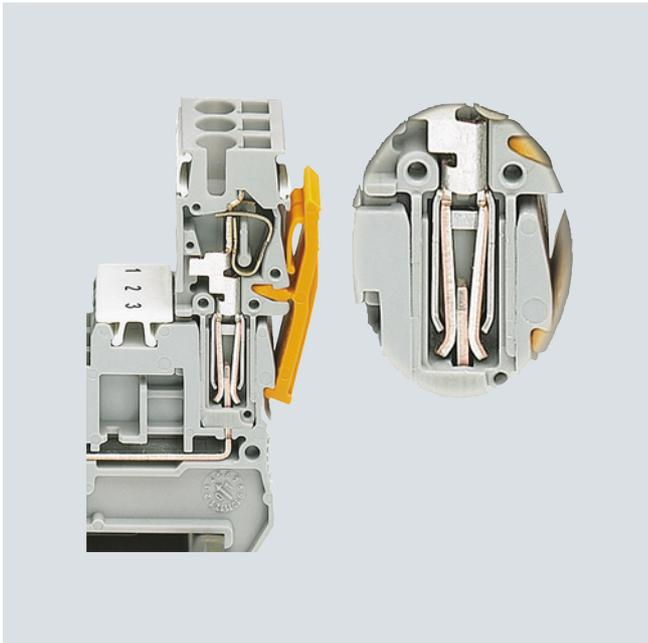
Le système perfectionné des blocs de jonction à connecteurs Combi permet de réaliser un câblage enfichable jusqu'à un courant nominal de 24 A ainsi qu'une tension nominale de 800 V. Du fait des ressorts de coiffe intégrés, le système de contact résiste aux contraintes vibratoires les plus extrêmes.
