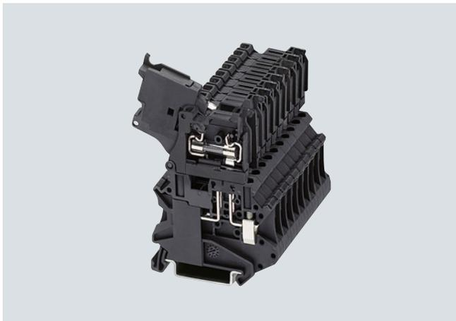
Les blocs de jonction 8WH jouent le rôle de porte fusible pour des cartouches fusibles G de 5 × 20 mm et 6,3 × 32 mm et assurent toutes les tâches de répartition des potentiels grâce au double logement pour cavaliers.
