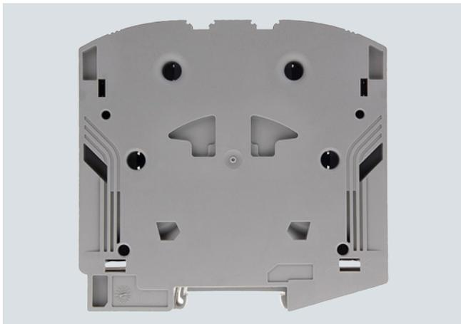
Les blocs de jonction traversants pour applications à courant fort 8WH6 sont particulièrement adaptés au câblage direct de conducteurs. Il existe 2 possibilités de câblage. Il suffit d'un tournevis standard et d'un simple mouvement de levier pour raccorder de façon simple et rapide des conducteurs de forte section.
