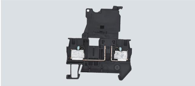
Le bloc de jonction à fusibles se distingue par sa forme très compacte et présente une forme identique aux blocs de jonction traversants et aux blocs de jonction fonctionnels. Un double pontage est possible. Il existe aussi des variantes à affichage lumineux pour la signalisation d'un fusible.
