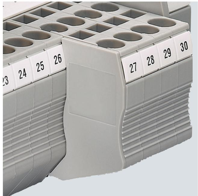
Des segments de couvercle assurent le recouvrement de segments saillants de blocs de jonction pour trois et quatre conducteurs en cas de mise en rangée de blocs de jonction pour deux conducteurs. La sécurité contre les contacts directs est ainsi garantie.
