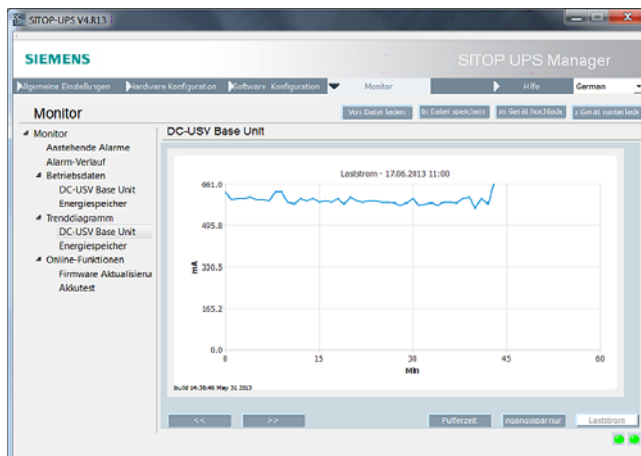
Diagramma di trend relativamente alla corrente di carico nel SITOP UPS Manager
