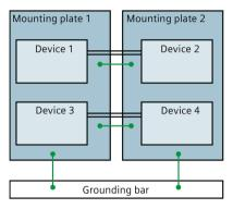
• High-frequency compatible equipotential bonding
