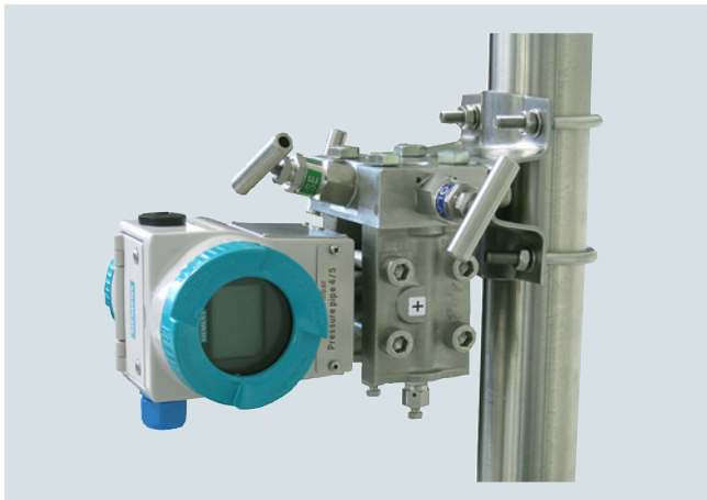
Manifold à vannes 7MF9411-5BA avec transmetteur de mesure de pression SITRANS P associé pour la mesure de la pression différentielle et de débit, série P500 (avec équerre de fixation)
