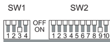
Figura 5-33 Ajuste de los interruptores DIP SW1 y SW2 en el momento del suministro
