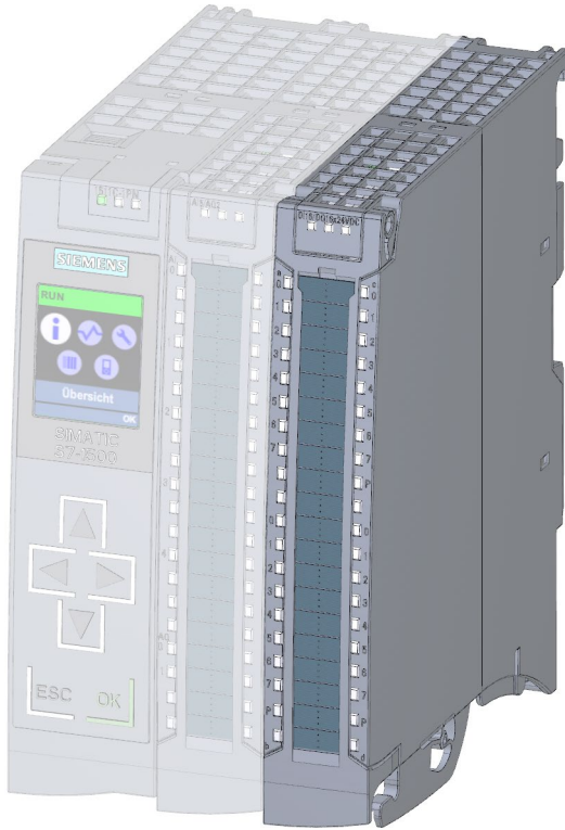
图 2-3 板载数字量 I/O
