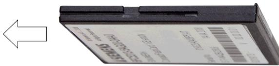
Desweiteren wird lediglich auf den Tausch der Systemsoftwarekarte eingegangen, weil diese durch eine verschraubte Metallabdeckung gesichert ist.
