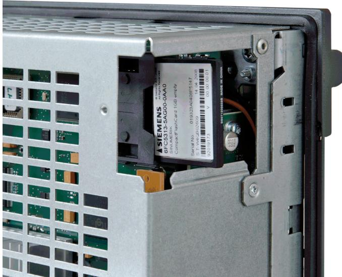
5. Stecken Sie die CompactFlash Card mit leichtem Druck in den Slot ③, bis sie einrastet.
