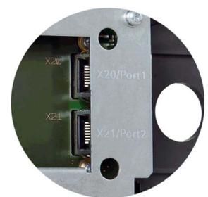
Bild 11-3 Rückseite des MCP 483C PN
