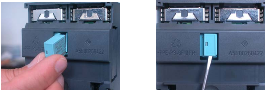
Figure 3-2 Mise en place du C-PLUG sur l'IE/PB Link PN IO et extraction du C-PLUG de l'IE/PB Link PN IO à l'aide d'un tournevis
