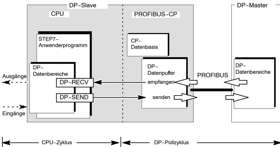
Bild 6-1 Zusammenspiel von CPU und PROFIBUS-CP im DP-Slavebetrieb
