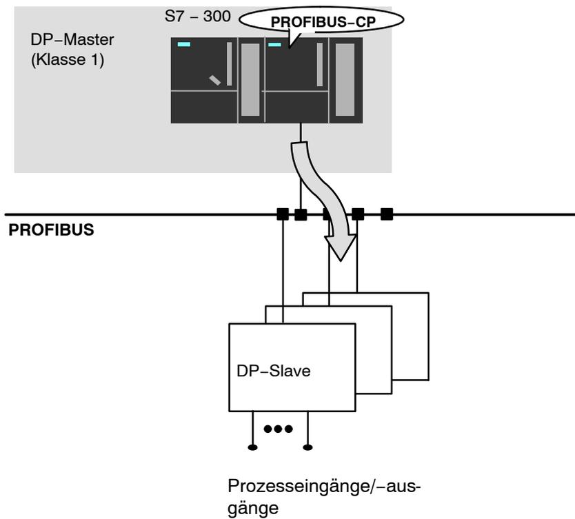
Bild 1-7 Buskonfiguration mit einem PROFIBUS-CP als DP-Master
