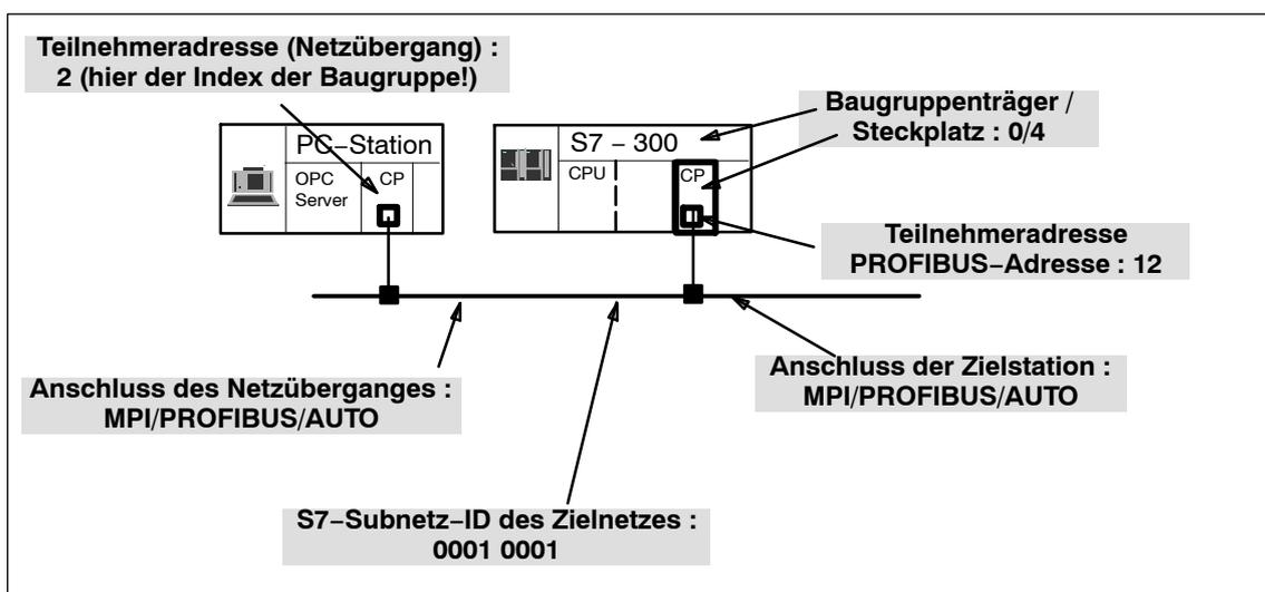
Bild 8-5 Beispiel für die Einstellung bei "PC internal"
