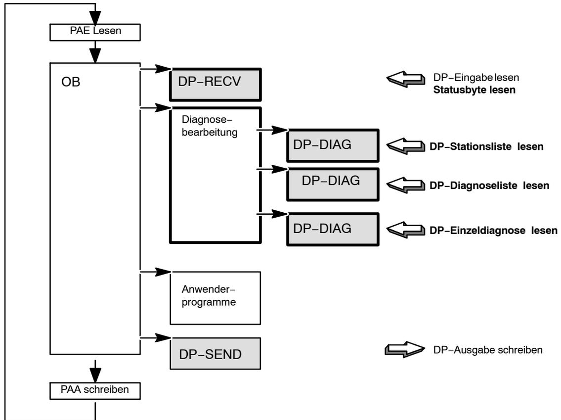
Bild 5-2 Typische Ablaufsequenz für DP-Funktionsbausteinaufrufe im CPU-Zyklus mit Diagnosebearbeitung
