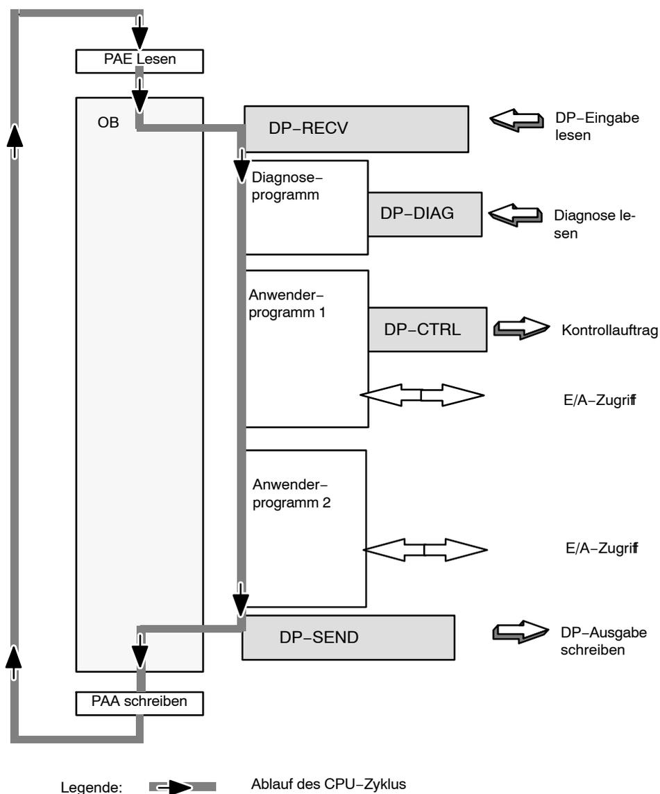
Bild 4-7 Typische Ablaufsequenz für DP-Funktionsbausteinaufrufe im CPU-Zyklus
