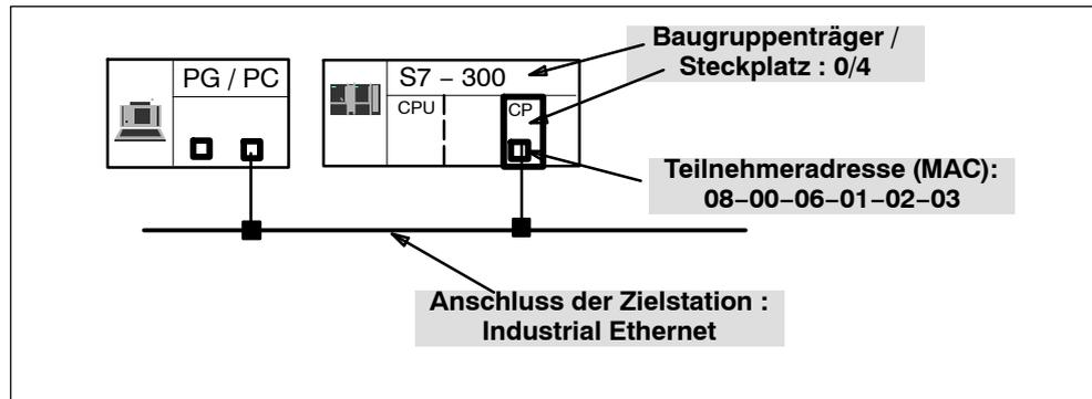
Bild 8-1 zu diagnostizierender CP ist direkt erreichbar
