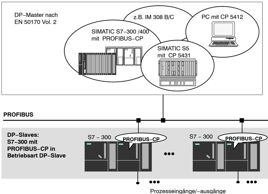
Bild 1-10 Netzkonfiguration mit SIMATIC S7-300 als DP-Slave
