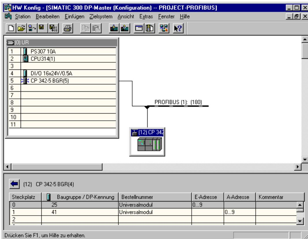
Bild 4-5 "Konfigurationstabelle Mastersystem" mit Detailansicht für einen DP-Slave
