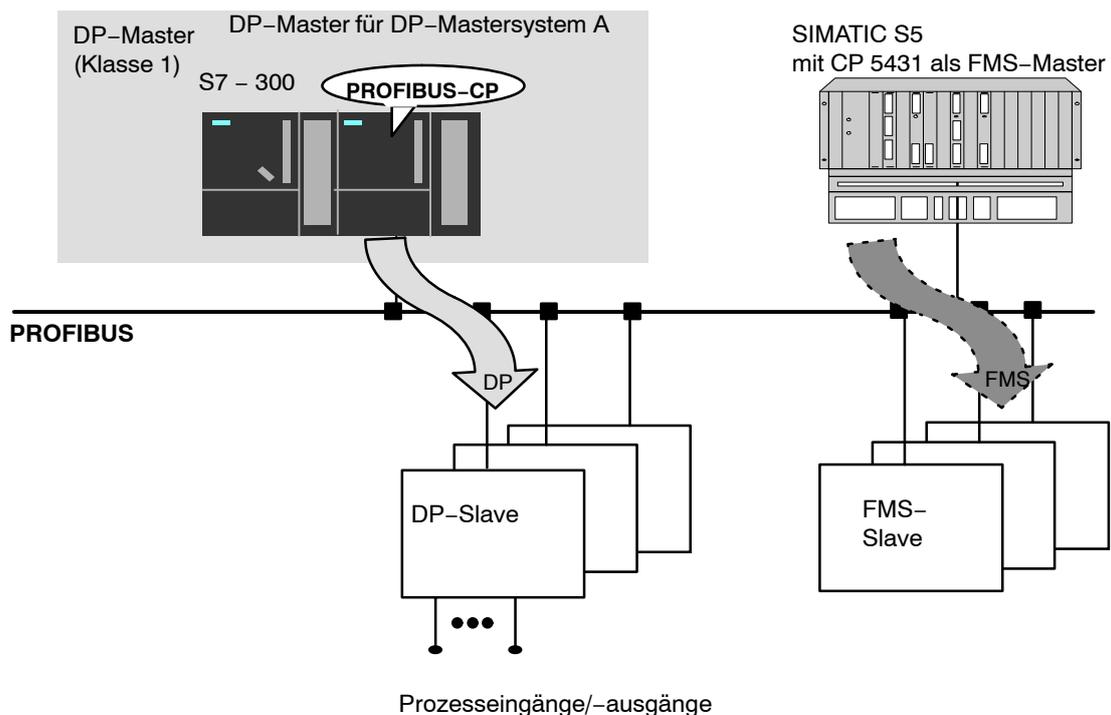
Bild 1-9 Buskonfiguration mit PROFIBUS-DP und FMS (mehrere Master)
