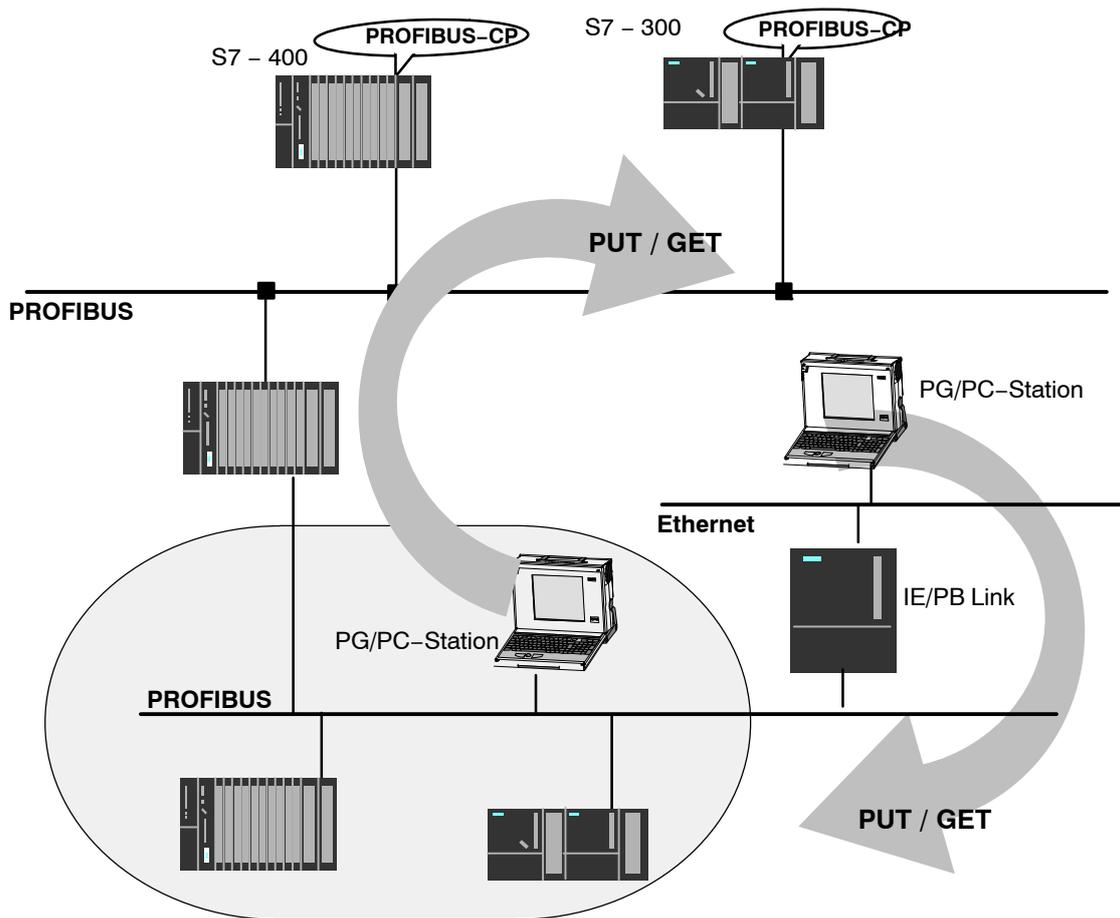
Bild 1-4 PG/PC-Station kommuniziert über Subnetzübergang mit S7-Stationen an unterlagertem PROFIBUS oder Ethernet
