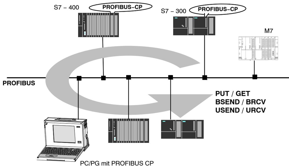
Bild 1-3 Teilnehmer kommunizieren mit S7-Verbindungen über PROFIBUS
