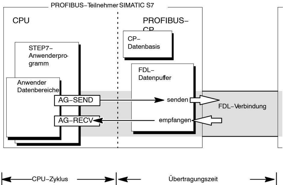
Bild 7-8 Zusammenspiel von CPU und PROFIBUS-CP bei FDL-Verbindungen
