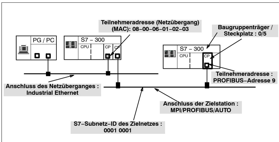
Bild 8-3 Beispiel für die Parametrierung des Online-Pfades mit einem Netzübergang
