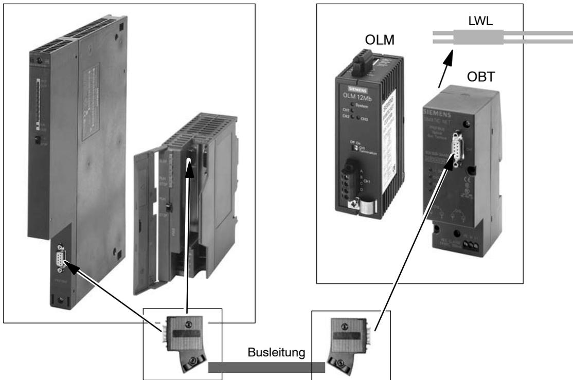
Bild 2-4 Übergang von elektrischem auf optischen Anschluss
