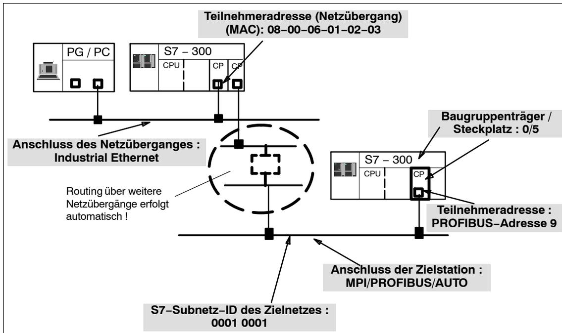
Bild 8-4 Beispiel für die Parametrierung des Online-Pfades mit mehreren Netzübergängen
