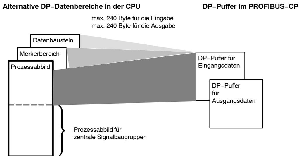
Bild 6-2 Zuordnung des DP-Prozessabbildes zu den CPU-Datenbereichen
