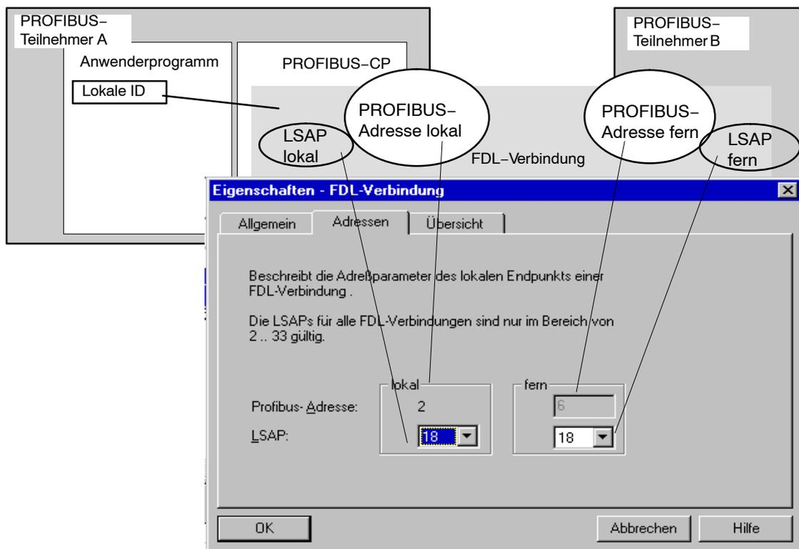
Bild 7-7 Zuordnung der Angaben im Register "Adressen" auf die Endpunkte der FDL-Verbindung
