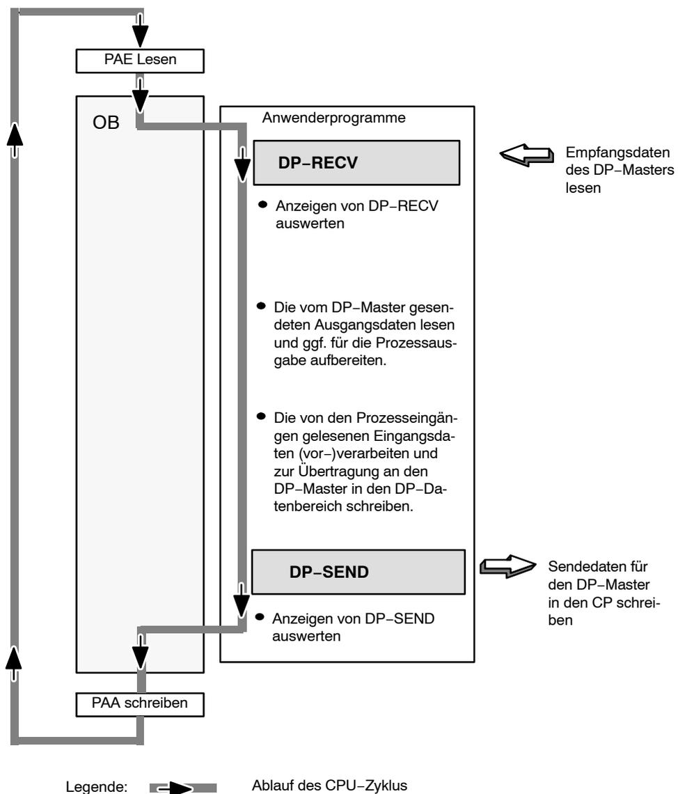
Bild 6-4 Typische Ablaufsequenz für DP-Funktionsbausteinaufrufe im CPU-Zyklus
