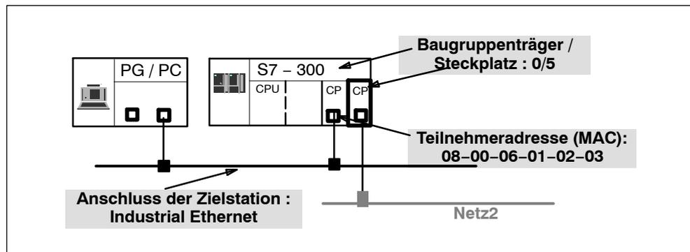
Bild 8-2 zu diagnostizierender CP ist indirekt über anderen CP erreichbar
