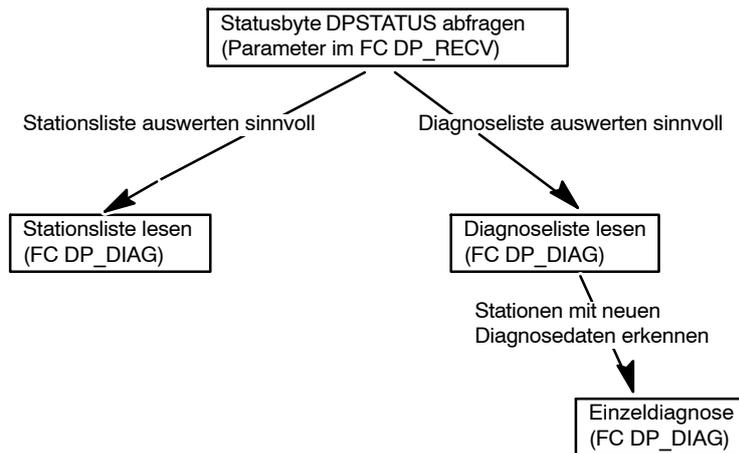
Bild 5-1 Entscheidungspfade für die bedingte Diagnose
