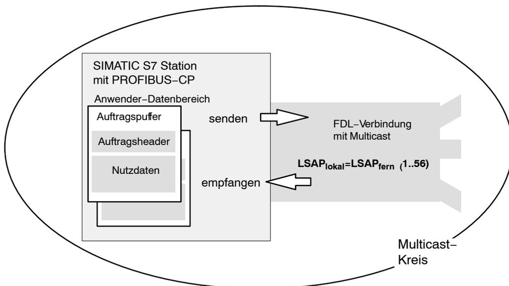
Bild 7-6 Senden und Empfangen über eine FDL-Verbindung mit Multicast- Adressierung per Programm
