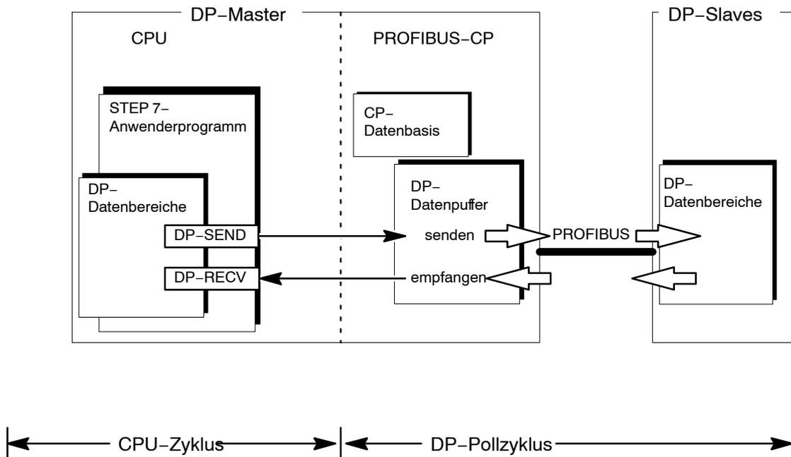
Bild 4-2 Zusammenspiel von CPU und PROFIBUS-CP im DP-Masterbetrieb
