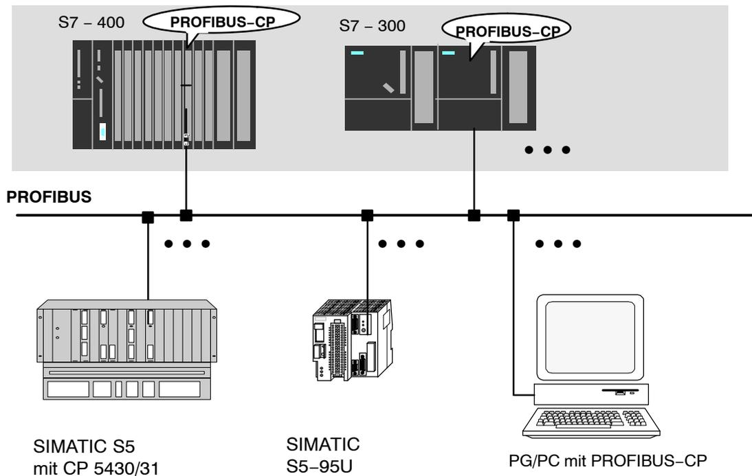
Bild 1-5 SIMATIC S7 mit möglichen Kommunikationsteilnehmern über FDL-Verbindungen
