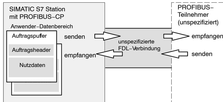
Bild 7-4 Senden und Empfangen über eine unspezifizierte FDL-Verbindung – Adressierung per Programm
