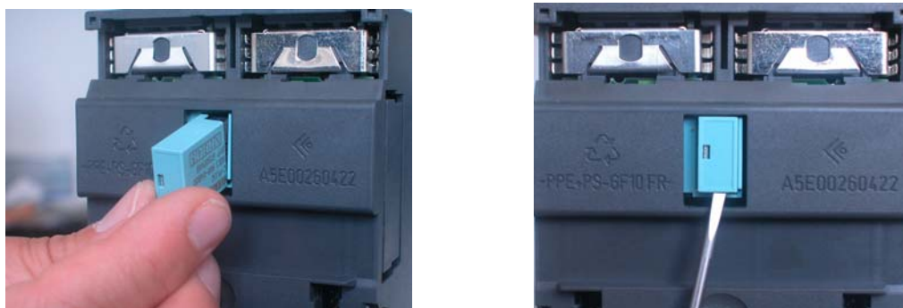
Figura 3-2 Colocar el C-PLUG y sacar el C-PLUG del CP con ayuda de un destornillador
