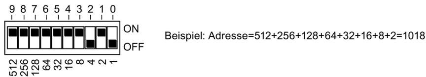
Bild 3-1 Beispiel für Einstellung des Adressschalters (DIL-Schalter)
