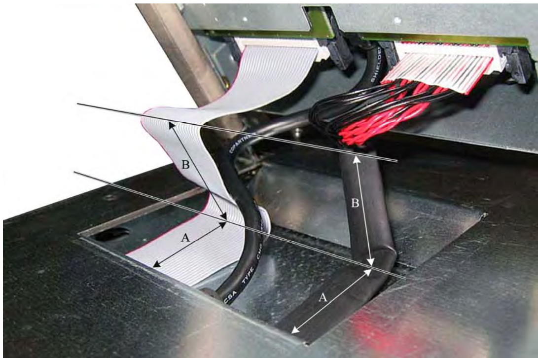
Bild 12-3 Bedieneinheit von Rechereinheit trennen, Beispiel zum Falten der Kabel
