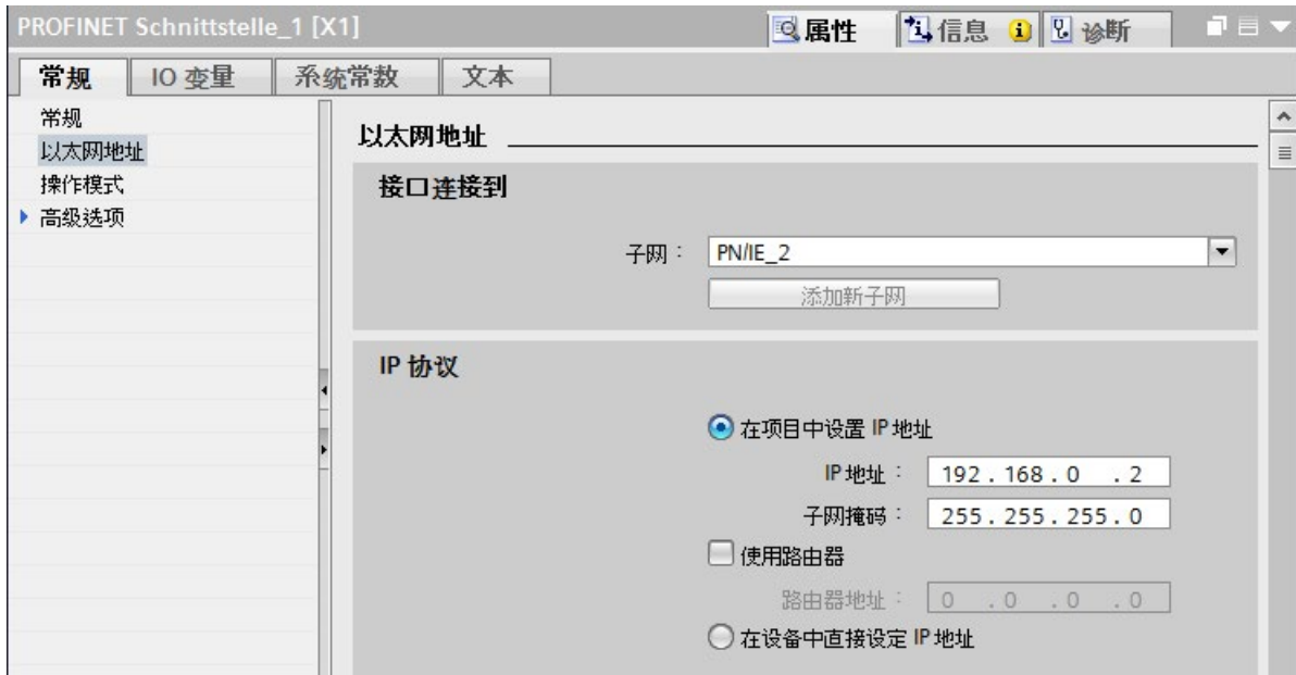
图 2-14 到“HMI 左侧”的 HMI 连接的 IP 地址已更改
