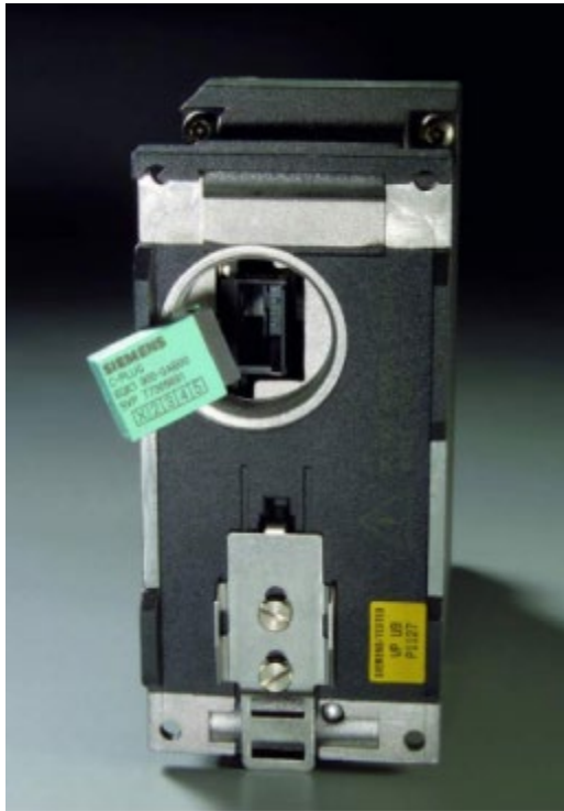
Bild 2-2 C-PLUG und Steckplatz
