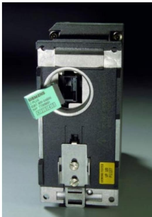
Figure 2-2 Emplacement de C-PLUG
