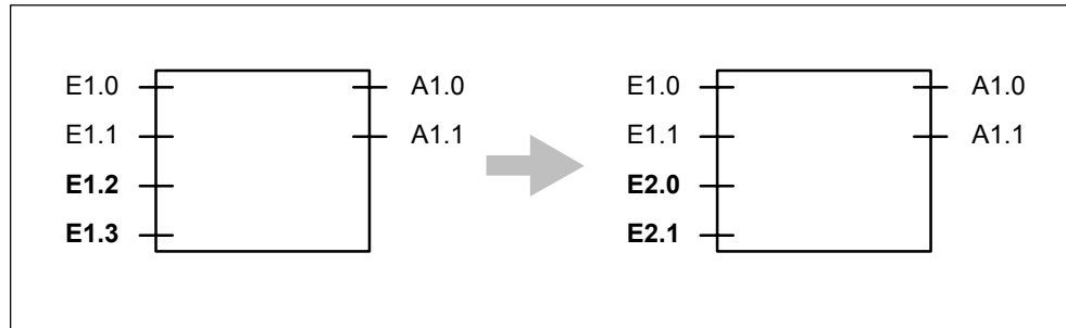
Bild 12-3 Beispiel: Umverdrahtung der Signale
