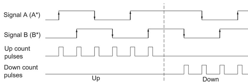
Figure 8-6 Quadruple evaluation
