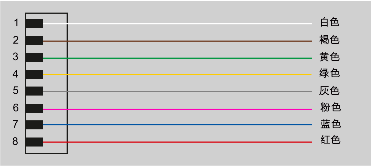
图 5-9 M8 连接器接线图
