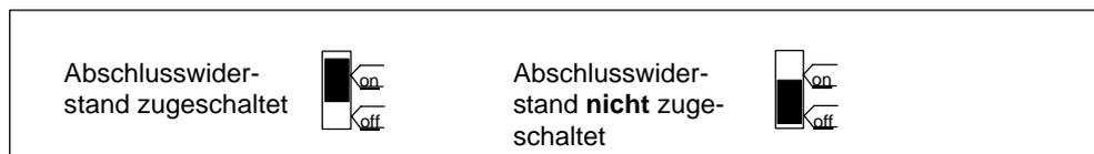
Bild B-1 Busanschlussstecker: Abschlusswiderstand zugeschaltet und abgeschaltet
