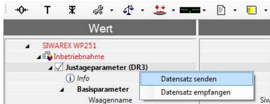
Bild 7-4 Senden / Empfangen eines Datensatzes / in SIWATOOL V7
