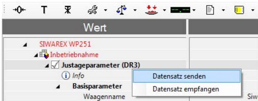
Bild 7-6 Senden / Empfangen eines Datensatzes in SIWATOOL V7
