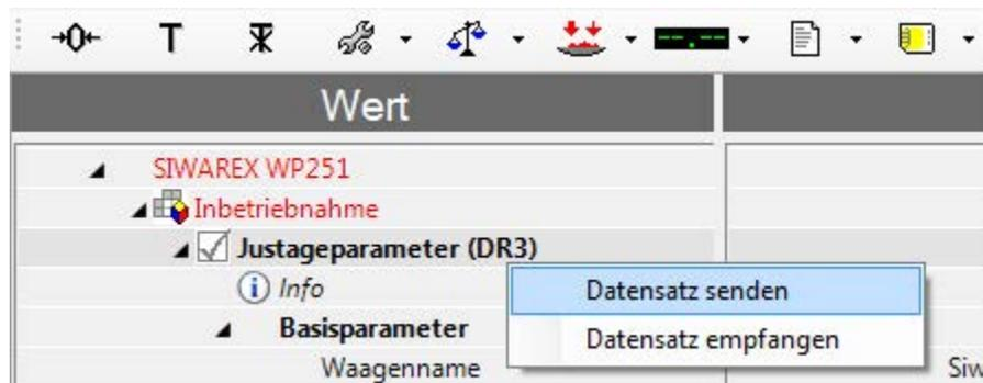
Bild 7-3 Senden / Empfangen eines Datensatzes / in SIWATOOL V7
