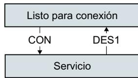
Con la orden CON, el convertidor conecta el motor. El convertidor pasa al estado "Servicio".
