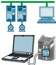
**STARTER** y **Startdrive** son herramientas de PC para la puesta en marcha, el diagnóstico y el control del convertidor, así como para la copia de seguridad y la transferencia de los ajustes del convertidor. Puede conectar el PC con el convertidor mediante USB o a través de bus de campo PROFIBUS/PROFINET.
