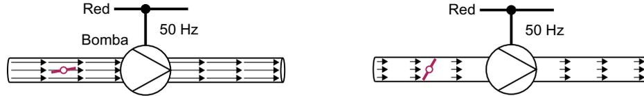
Figura 6-67 Regulación de flujo con bomba y válvula de mariposa en una red de 50 Hz
