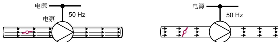
图 6-67 50 Hz 电源上使用泵和节流阀的流体控制
