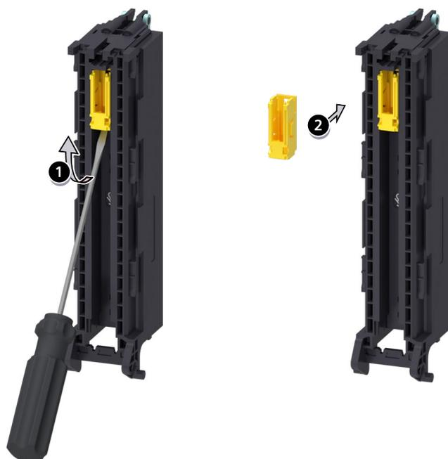
图 15-10 从前连接器移除电子编码元件并插入新的前连接器中
