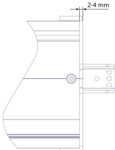
图 7-7 DIN 导轨适配器突出
