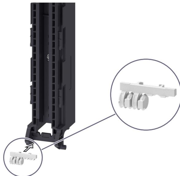
图 15-9 将机械编码元件插入新的前连接器中
