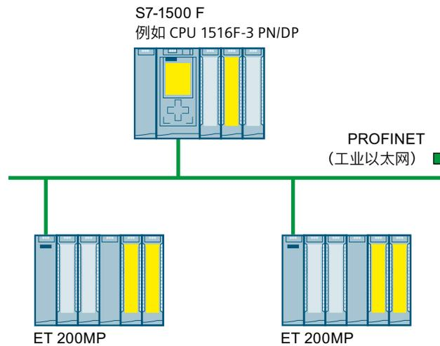
图 5-12 故障安全自动化系统 SIMATIC Safety (示例)
