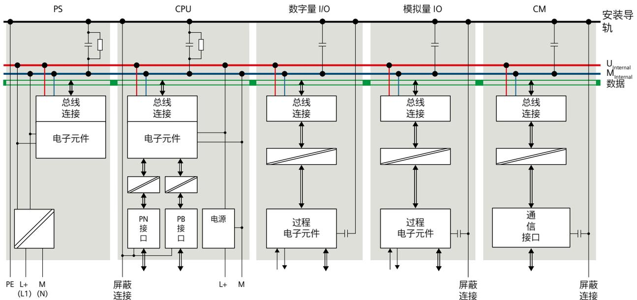
图 8-2 S7-1500 的电位关系（以 CPU 1516-3 PN/DP 为例）
