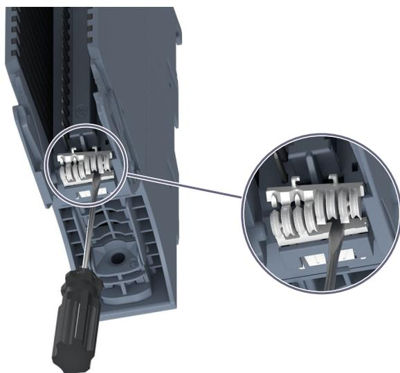
图 15-7 将编码元件从 I/O 模块撬出
