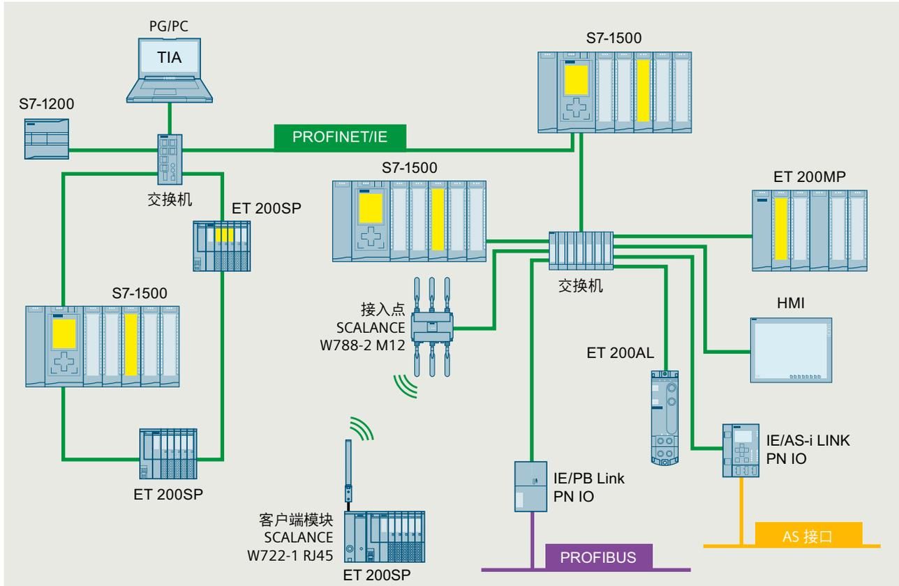
图 5-6 示例：配有 SIMATIC S7-1500 和 Safety on PROFINET 的工厂组态
