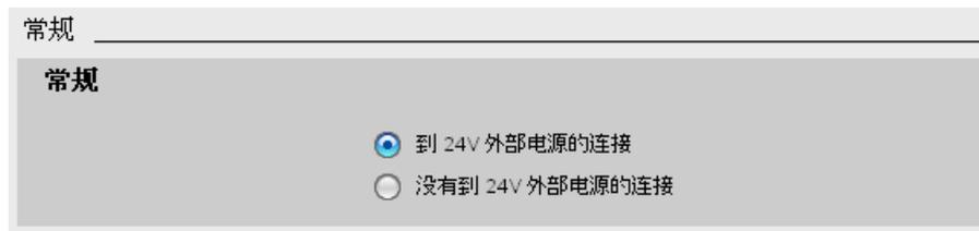
图 6-6 仅通过 CPU/接口模块供电
