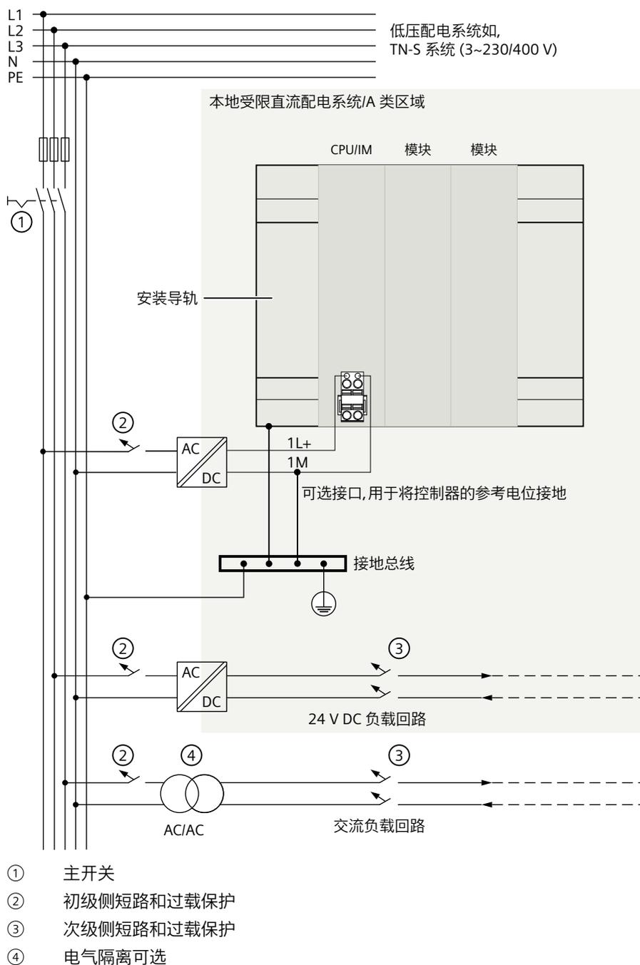
图 8-1 参考电位接地时, S7-1500/ET 200MP 的操作方式
