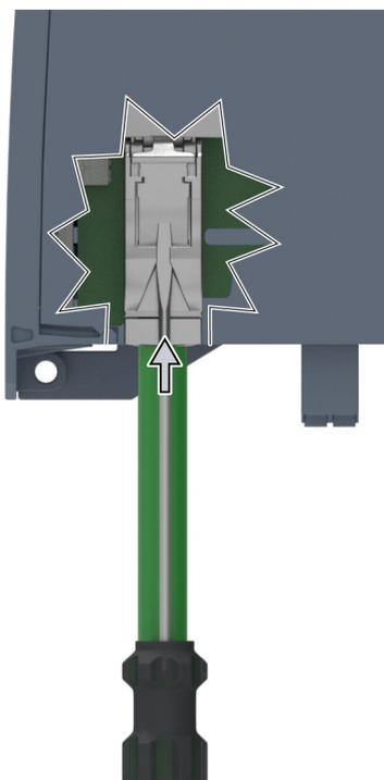
图 8-8 解锁 FastConnect 连接器
