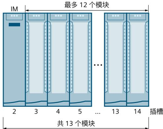
图 6-3 带有 IM 155-5 DP 的 ET 200MP 最大组态
