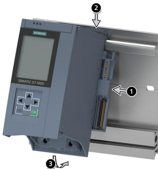
图 7-11 安装 CPU
