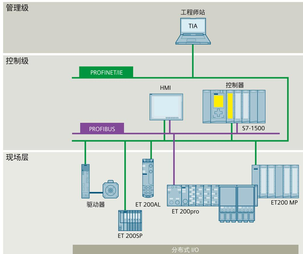
图 5-2 基本架构：SIMATIC S7-1500 的管理层、控制层和现场层设置
