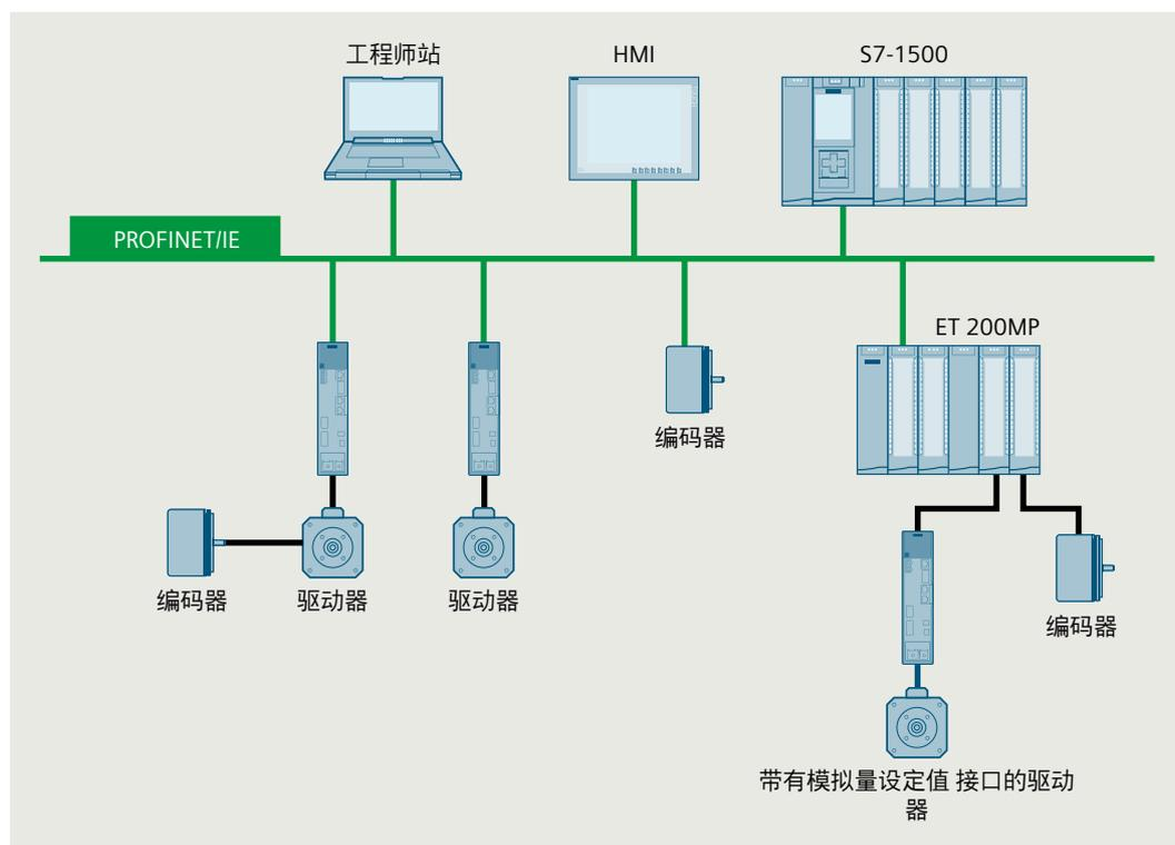
图 5-22 运动控制的组态示例
