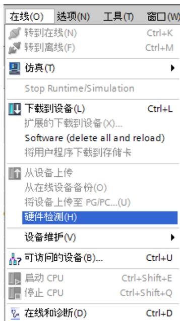
图 9-2 在线菜单中的硬件检测
