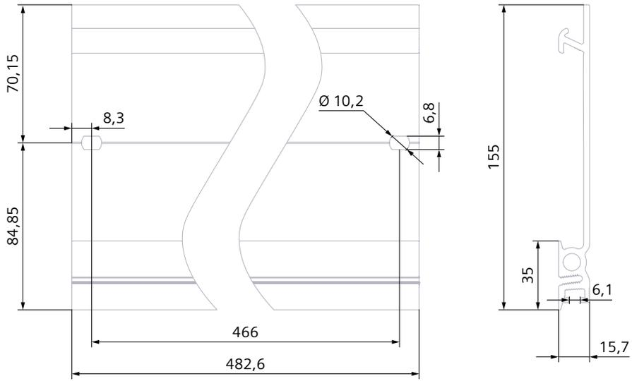
图 A-3 安装导轨 482.6 mm
