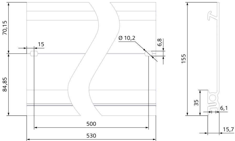
图 A-4 安装导轨 530 mm
