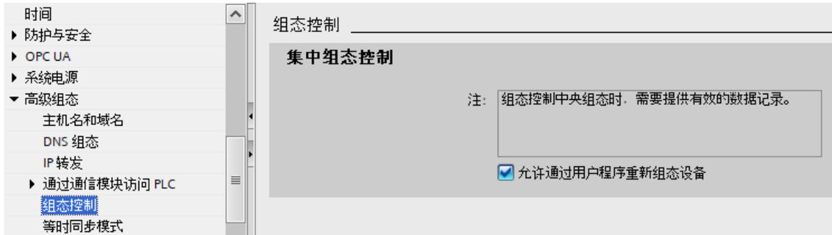
图 12-2 以 S7-1500 CPU 为例，启用组态控制
