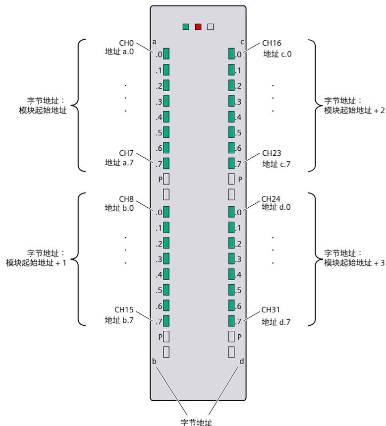
图 9-7 分配通道地址的示例（数字量模块）
