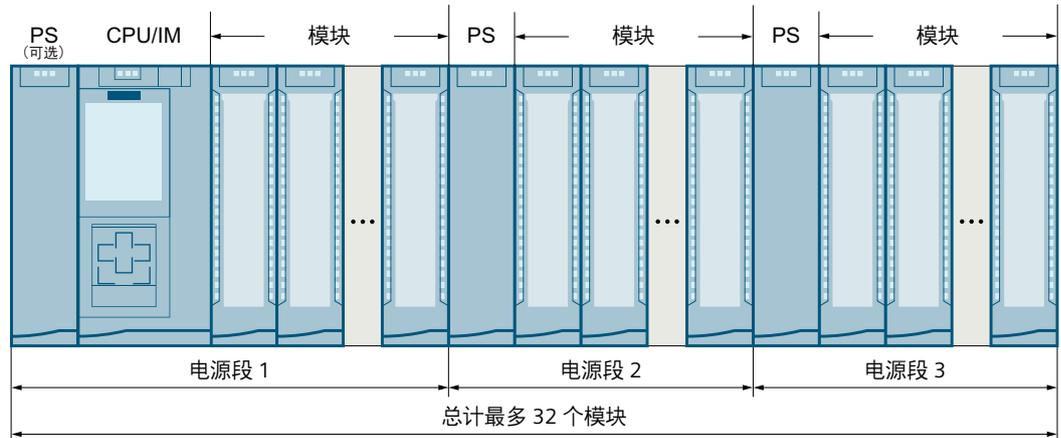
图 6-5 带有 3 个电源段的配置型式
