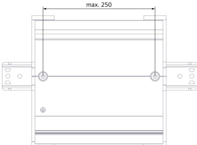
图 7-6 两个 DIN 导轨适配器之间的距离
