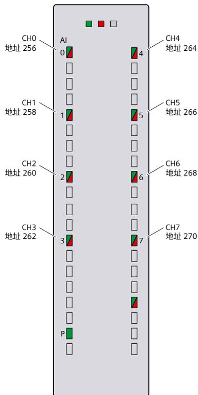
图 9-8 分配通道地址的示例（模拟量模块）
