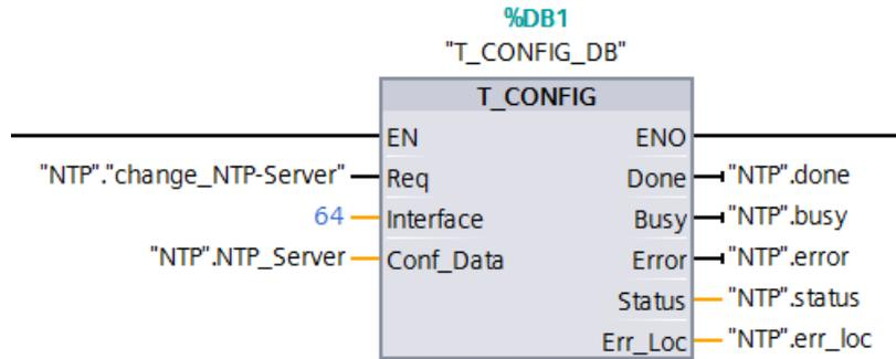
图 13-5 T\_CONFIG 示例：设置 NTP 服务器
