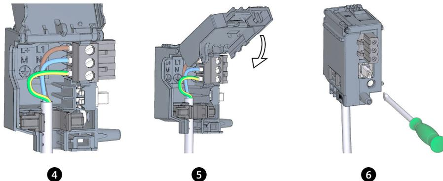
图 8-7 将电源电压连接到系统电源/负载电流电源 (2)
