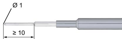
图 A-15 测量端测试探头的尺寸图
