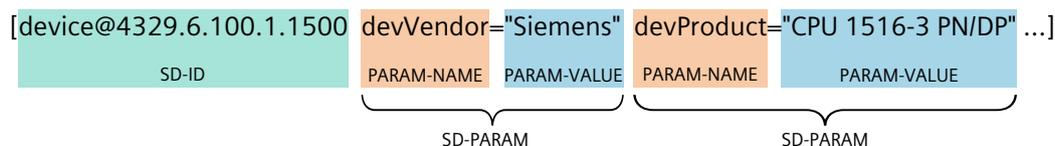
图 4-6 示例：CPU 的 syslog 消息的 SD 元素
