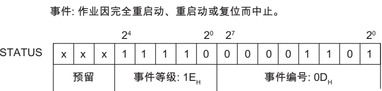
图 2-24 示例：“事件类别 1EH，事件 0DH”的 STATUS 参数
