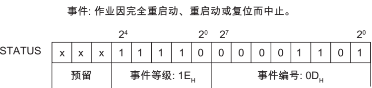
图 3-20 示例：“事件类别 1EH，事件 0DH”的 STATUS 参数
