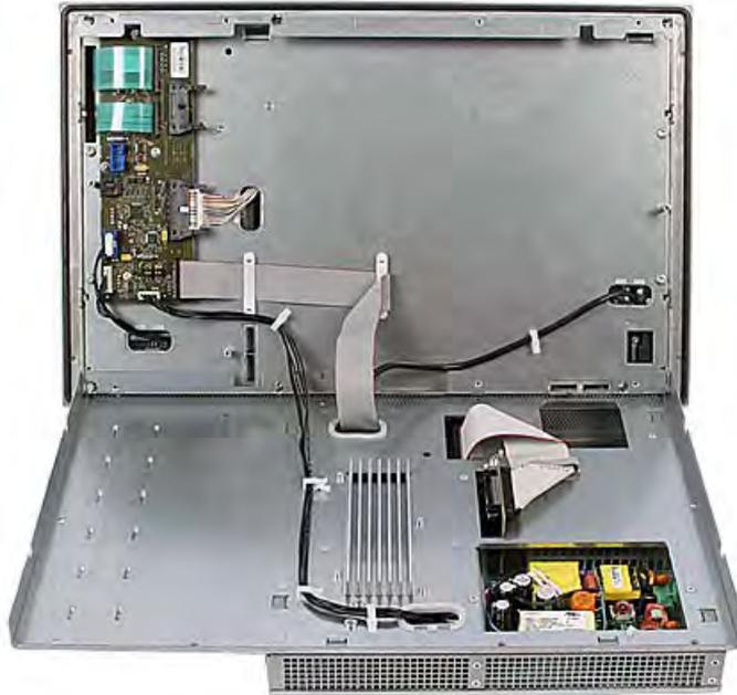
Bild 4-2 Beispiel 12"-Touchscreen-Gerät: Rechereinheit von Bedieneinheit trennen
