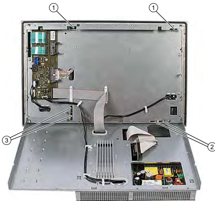
Bild 4-3 Geräterückseite mit Anschlüssen und Schlitzen für die Beschriftungstreifen
