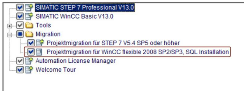
Bild 3-1 Setup von WinCC (TIA-Portal): Optionskästchen für Projektmigration setzen
