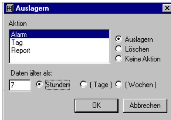
Im Dialogfenster zur manuellen Auslagerung können Sie getrennt für jede Datenart festlegen, wie die Daten zu behandeln sind. Über den Offset legen Sie fest, wie alt die Daten mindestens sein müssen, um von der "manuellen Auslagerung" bearbeitet zu werden.
