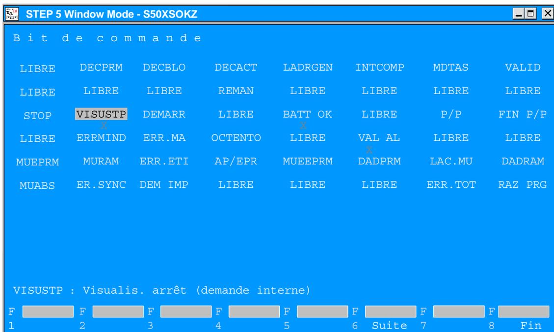
Figure 17-1 Masque des bits de commande (CPU 928B)
