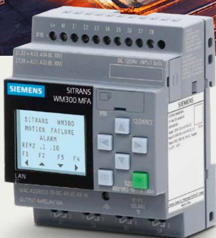
**SITRANS WM300 MFA** – erkennt Veränderungen in der Bewegung und Geschwindigkeit rotierender, hin- und hergehender oder fördernder Geräte. Es warnt vor Gerätestörungen und signalisiert über Kontakte, dass die Maschine im Falle einer Verlangsamung oder eines Ausfalls abgeschaltet wird.
