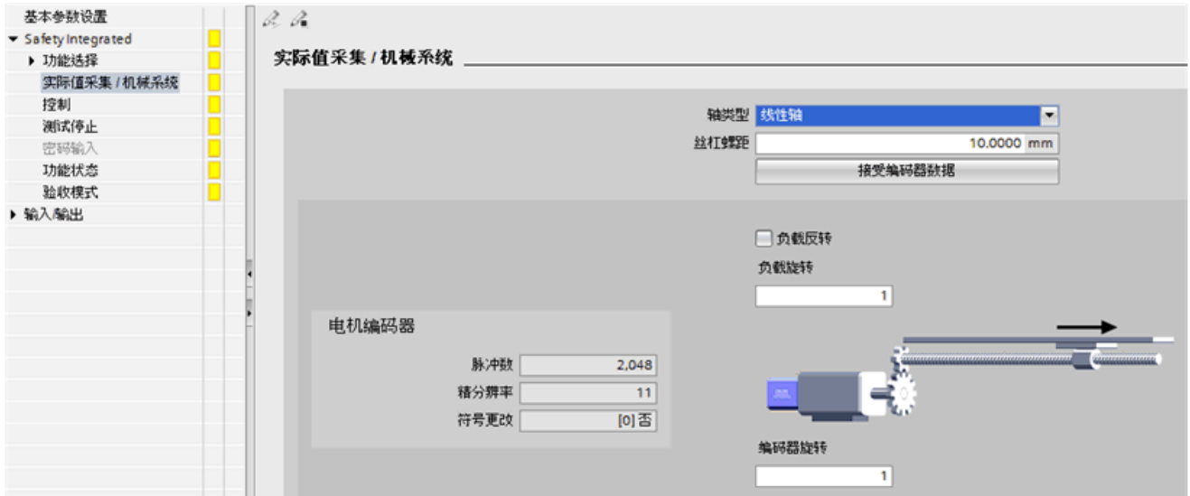
图 7-12 实际值采集/机械装置
