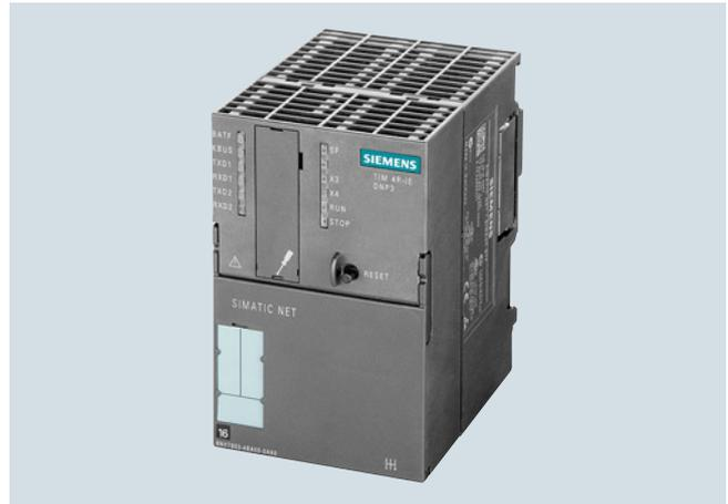
Die Kommunikationsbaugruppe TIM 4R-IE DNP3 (Telecontrol Interface Module) wickelt in einer Station für die S7-CPU den Datenverkehr zu dem zugeordneten Master-System SIMATIC PCS 7 TeleControl V8.0 mit dem offenen DNP3-Protokoll ab. Zusätzlich unterstützt die Baugruppe mit der V3.0 nun auch die Master- und Knotenfunktionalität.
