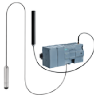
SIMATIC RTU3030C mit Mobilfunkantenne und dem Druckmesser SITRANS LH100 zur hydrostatischen Füllstandmessung.
