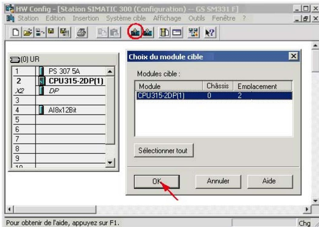
Figure 6-11 Charger la configuration matérielle sur la CPU (1)
