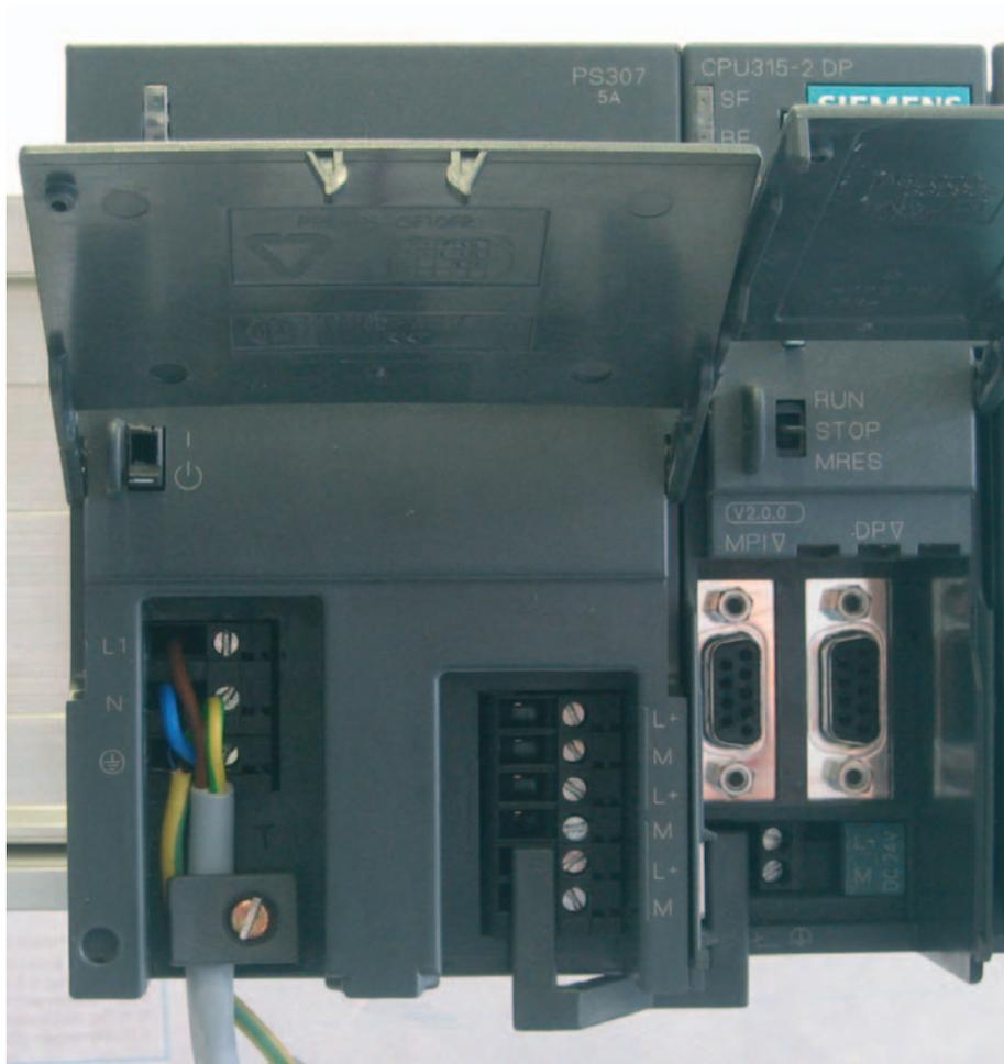
Figure 5-1 Câblage de l'alimentation et de la CPU
