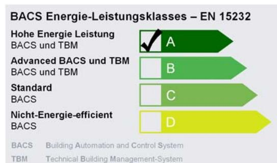
Bild 3-7: Energie-Klassifizierung von Gebäuden nach EN 15232
